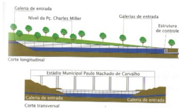
Figura 5: Concepção Geral do Reservatório.
