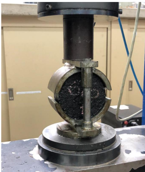
Figura 17 – Ruptura do CP
