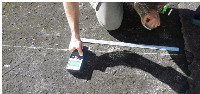
Figura 3.10 – Ensaio de pacometria sendo realizado
