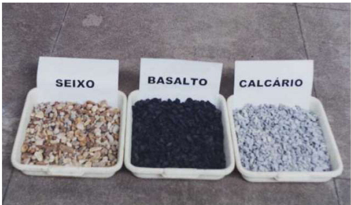
Figura 3.2 – Agregados graúdos utilizados na confecção dos concretos.
