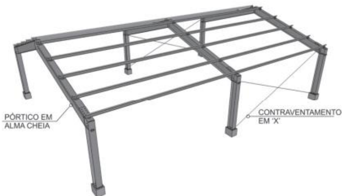
Figura 2: Edifício industrial com colunas e vigas de alma cheia
