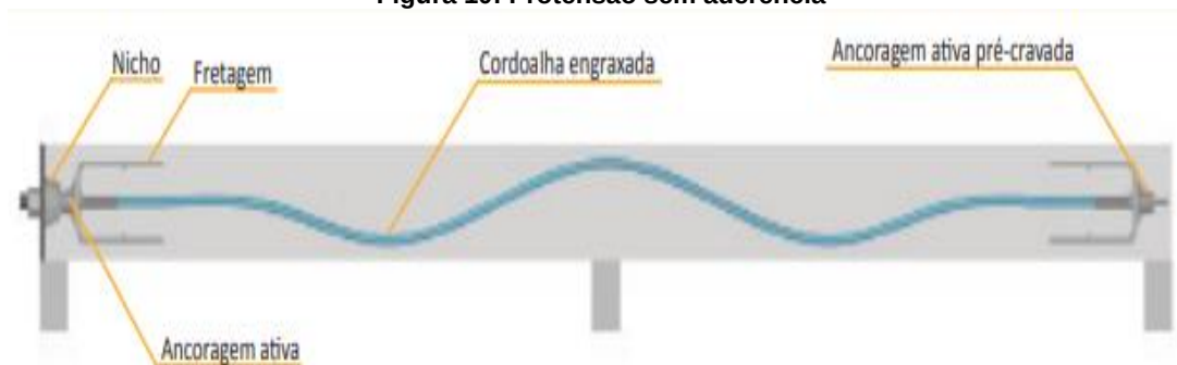
Figura 10: Protensão sem aderência
