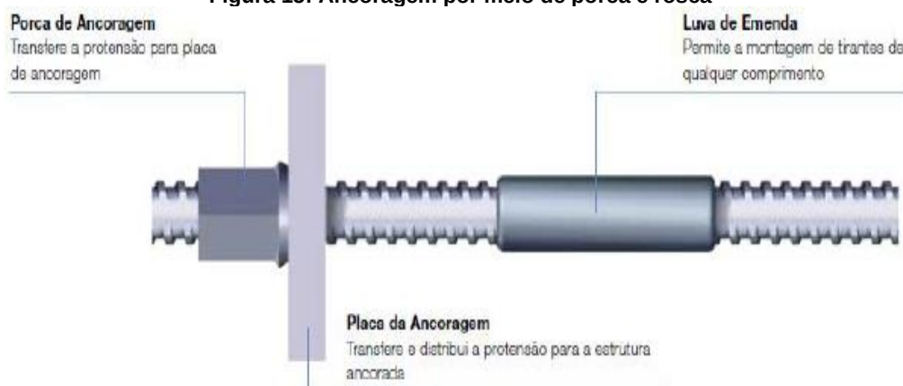
Figura 15: Ancoragem por meio de porca e rosca
