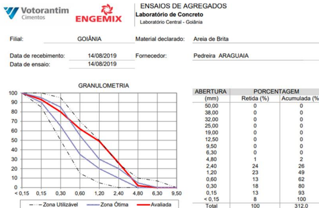
Figura 3.9 - Caracterização granulométrica do agregado miúdo (areia de brita)
