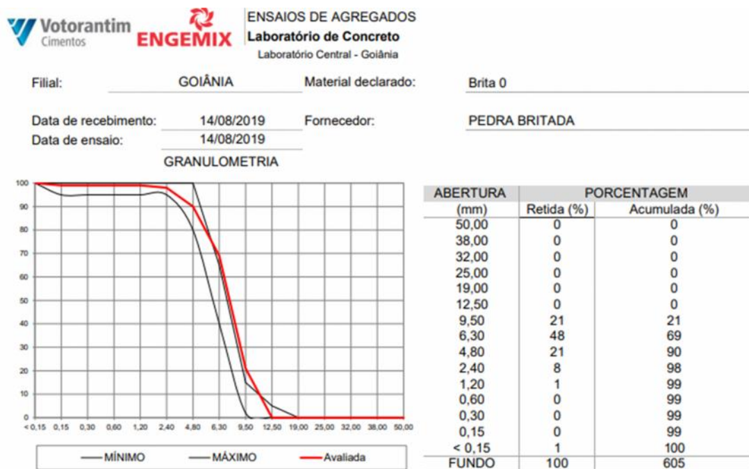
Figura 3.7 - Caracterização granulométrica do agregado graúdo
