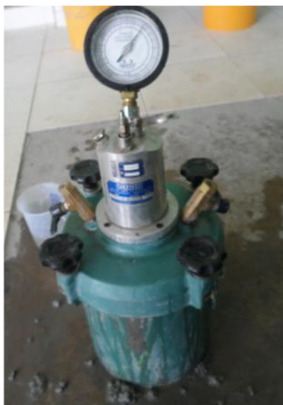
Figura 3.11 – Aparelho para aferição do teor de ar incorporado ao concreto
