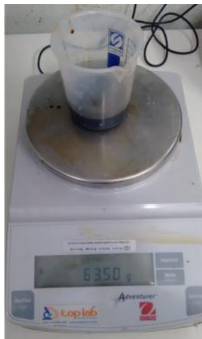
Figura 3.6 – Pesagem de aditivo em balança de precisão
