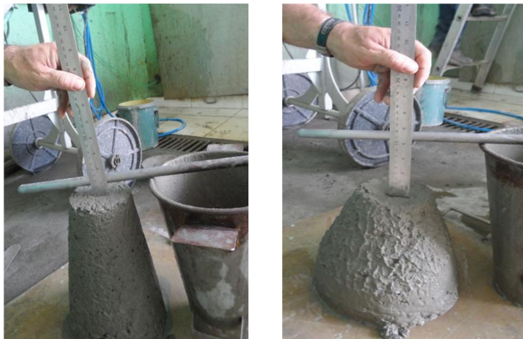
Figura 3.3 – (a) Slum Test sem a presença de aditivo (b) Slump Test com utilização de aditivo polifuncional
