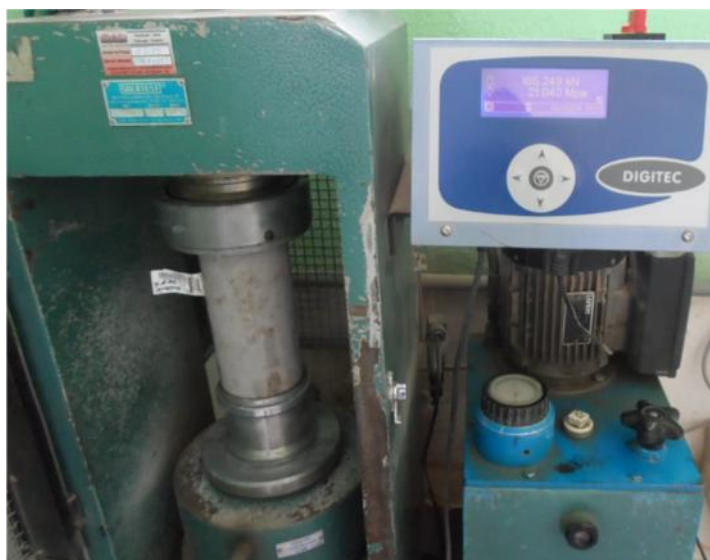
Figura 3.12 – Prensa durante ensaio de resistência à compressão
