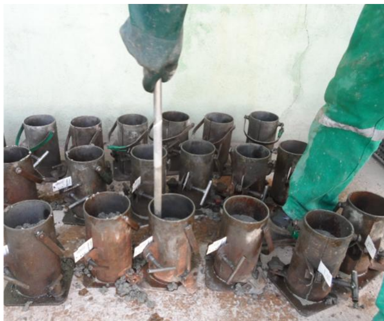
Figura 3.4 – Adensamento durante a moldagem dos corpos de prova
