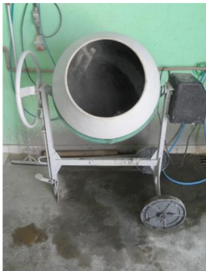
Figura 3.10 – Betoneira utilizada para realizar a mistura do concreto
