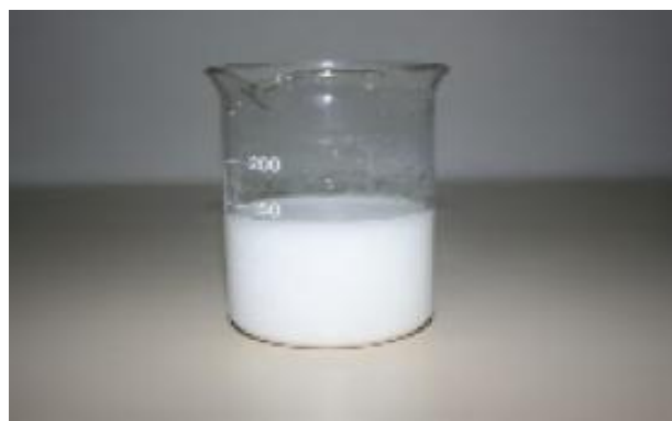
Figura 6: Nanotubos de titânio em meio aquoso (a) e \text{TiO}_2 (b) na mesma concentração (2,0 g em 150 mL). Destaca-se a rápida deposição do catalisador após 60 segundos de repouso
