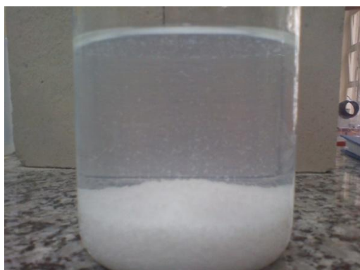
Figura 6: Nanotubos de titânio em meio aquoso (a) e \text{TiO}_2 (b) na mesma concentração (2,0 g em 150 mL). Destaca-se a rápida deposição do catalisador após 60 segundos de repouso
