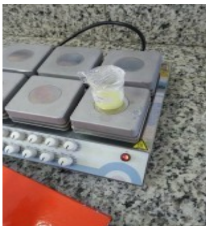
Figura 6 – Agitação Magnética da solução do corante amarelo tartrazina.
