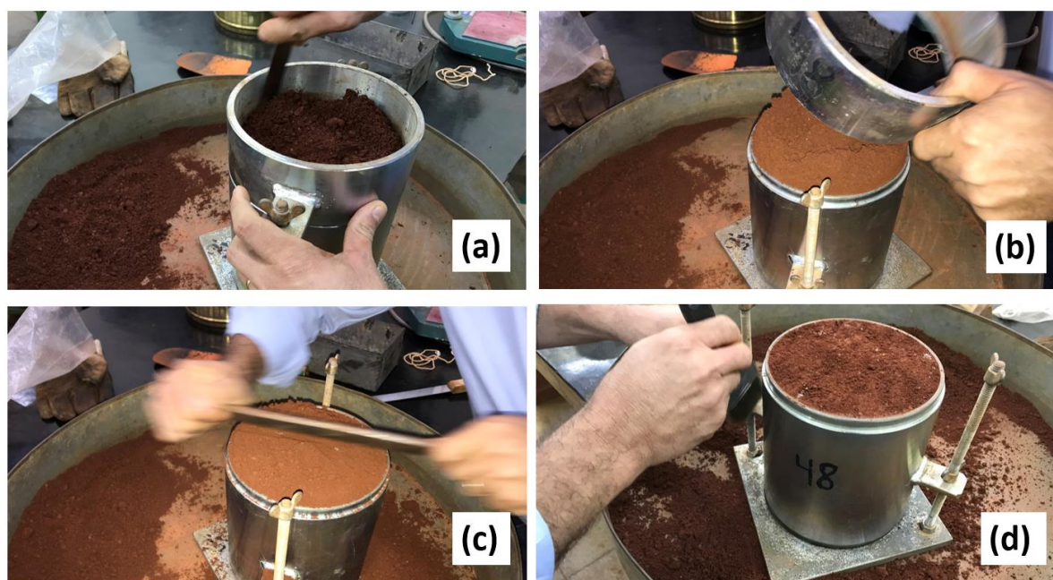
Figura 3.15 – Escarificação e remoção do colarinho (a) e (b), retirada de material em excesso (c) e limpeza do cilindro (d)
