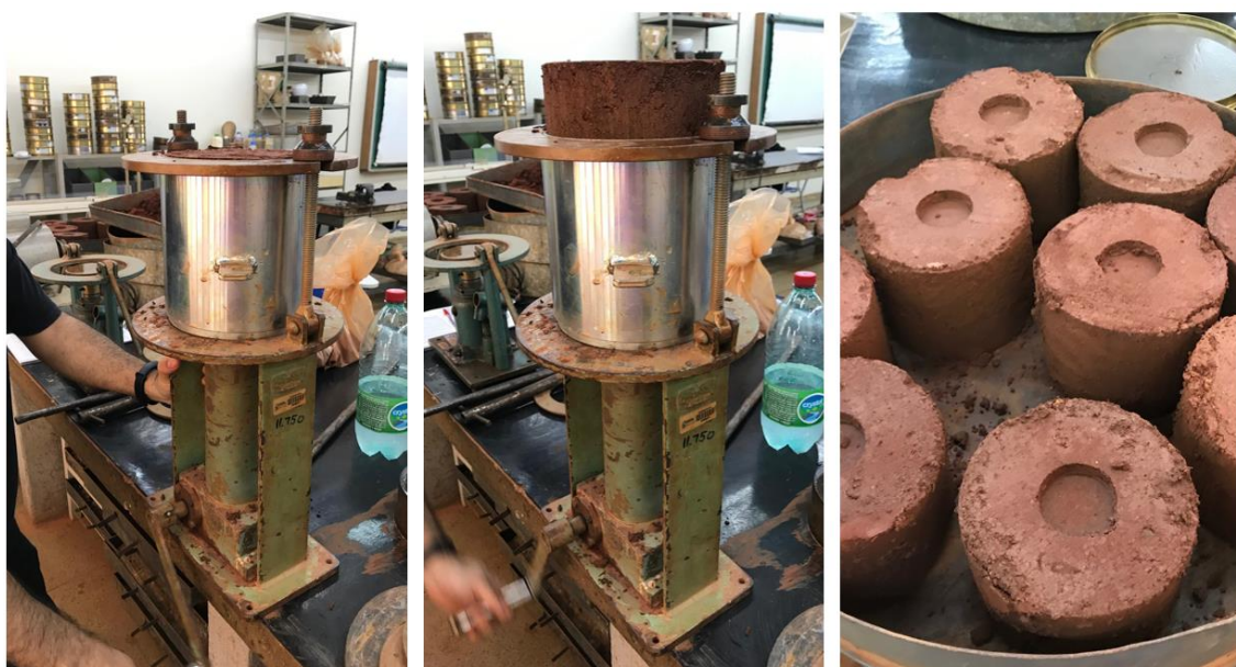
Figura 3.24 – Extração dos corpos-de-prova
