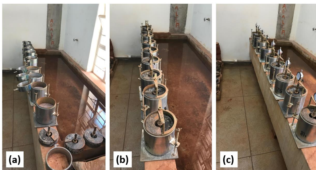
Figura 3.18 – Execução do ensaio de expansão
