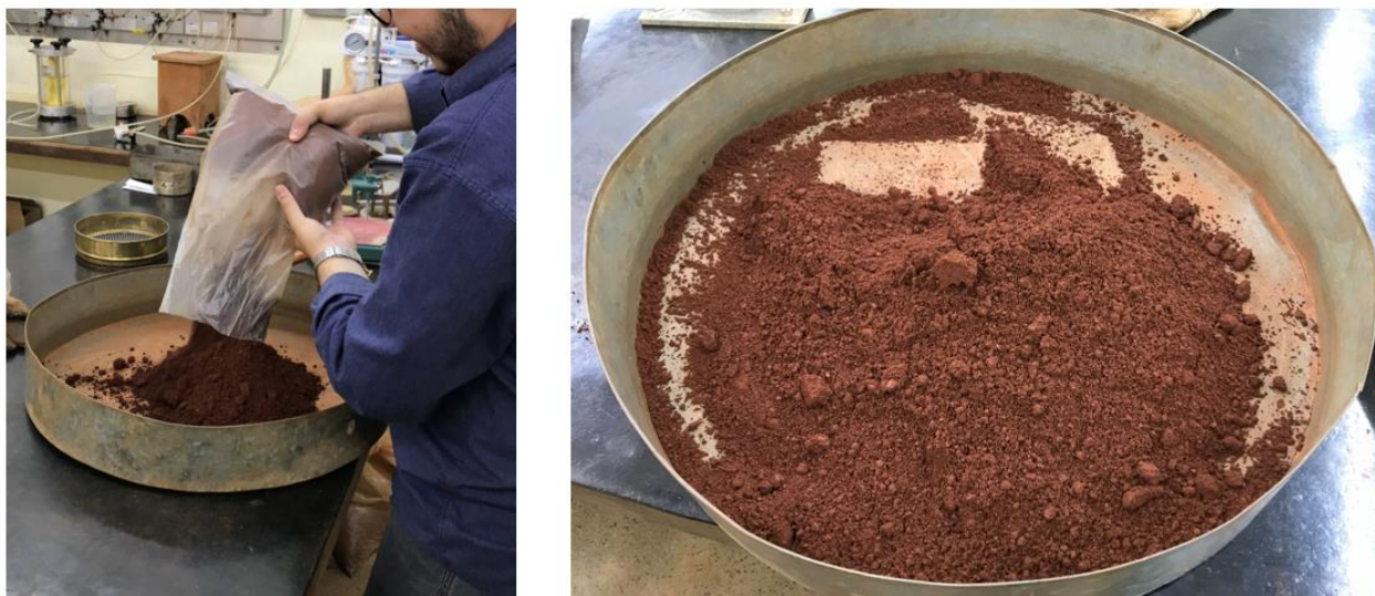
Figura 3.11 – Amostras na umidade ótima homogeneizadas
