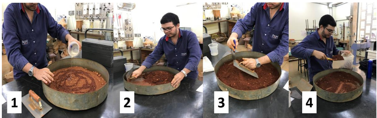
Figura 3.8 – Umidificação da amostra na umidade ótima ( w_{ot} )
