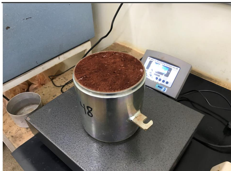
Figura 3.16 – Pesagem do conjunto
