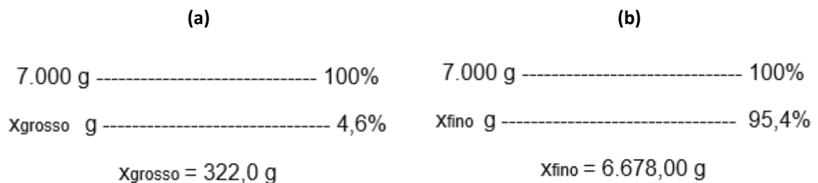
Figura 3.5 – Cálculo das amostras retidas (a) e passantes (b) na peneira Nº 4 para amostra total de 7.000 g
