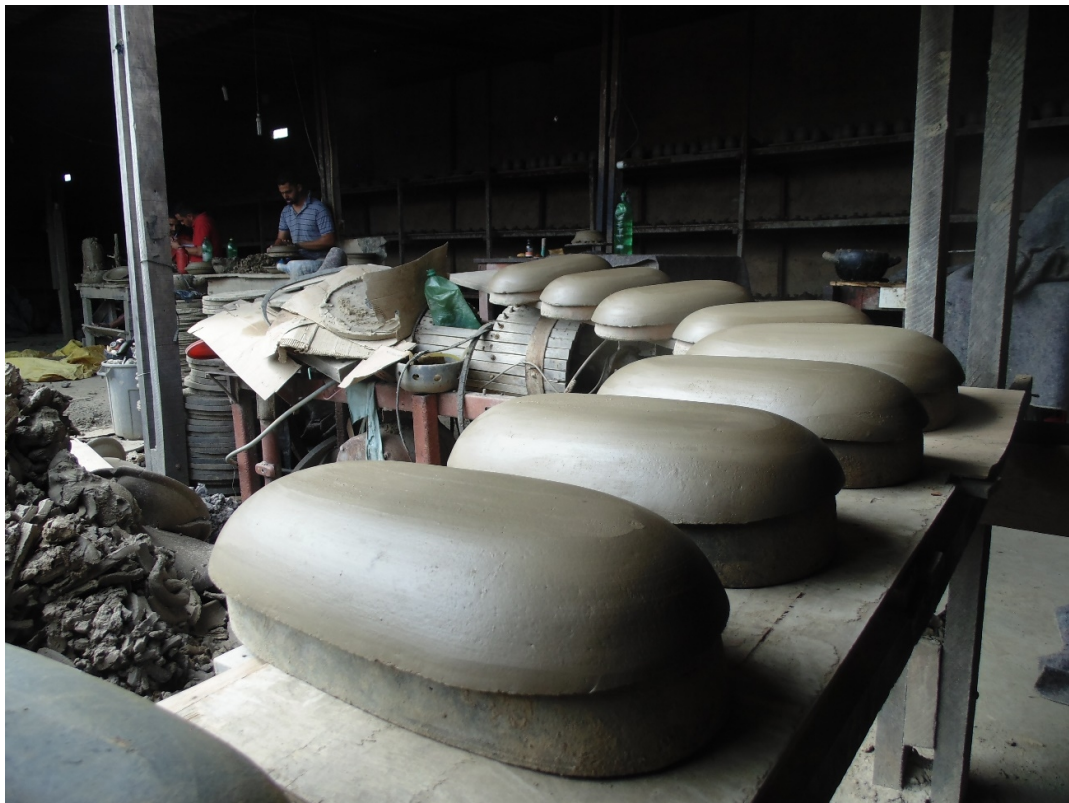
Figura 16: Telhas em processo de tirar a fôrma
