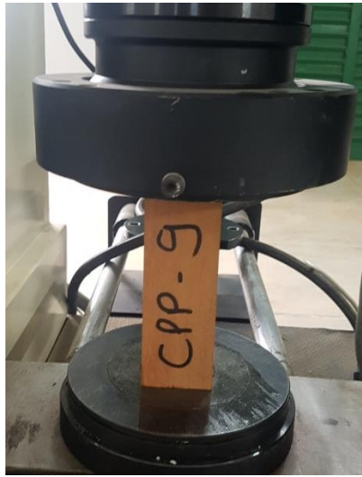
Figura 7 – Corpo-de-prova preparado para o ensaio de compressão paralela à fibras.
