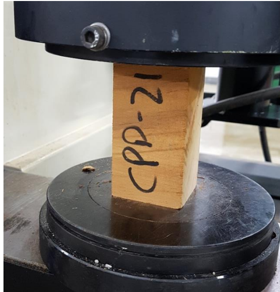
Figura 8 – Corpo-de-prova após a ruptura no ensaio de compressão normal à fibras.
