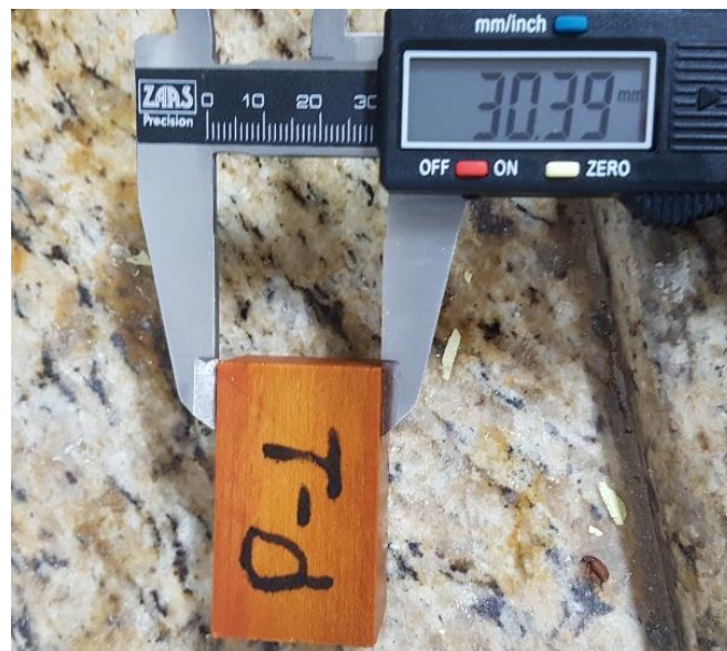
Figura 6 – Determinação das dimensões dos corpos-de-prova com paquímetro para determinação da densidade básica.
