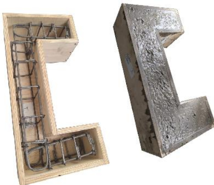
Figura 18 – Etapas da moldagem dos pilaretes.
