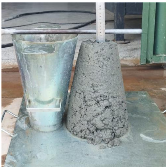
Figura 10 – Ensaio de abatimento do concreto pelo método do tronco de cone.
