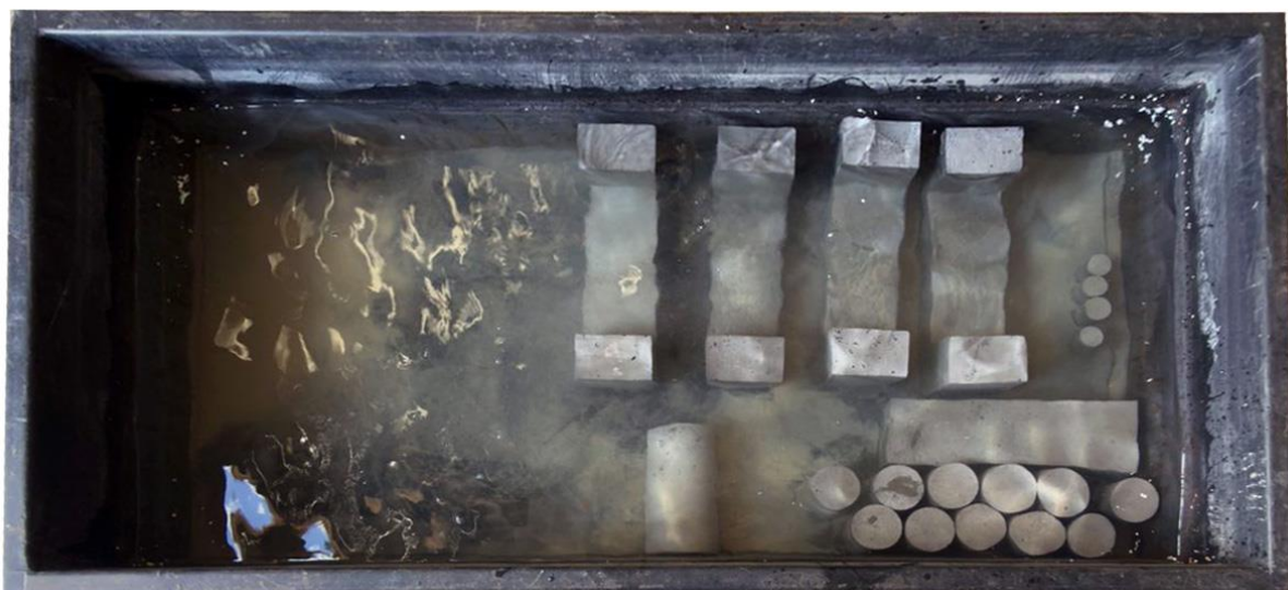
Figura 9 – Cura úmida dos corpos de prova e dos pilaretes em tanque com água.
