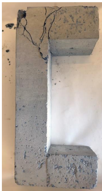
Figura 16 – Ruptura observada no ensaio preliminar do pilarete teste.
