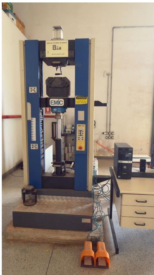
Figura 19 – Prensa hidráulica EMIC DL20000 utilizada nos ensaios.
