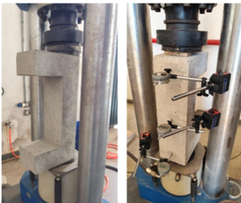
Figura 21 – Configuração experimental utilizada nos ensaios dos pilaretes.
