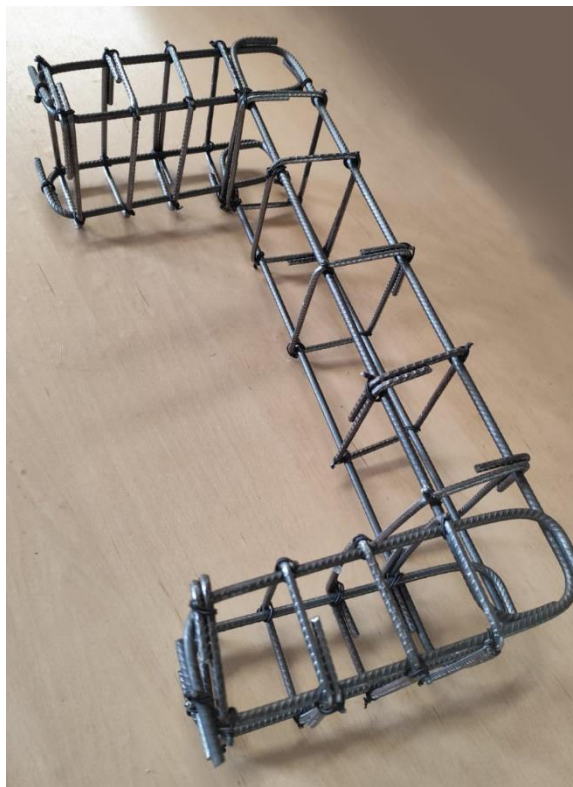
Figura 14 – Armadura original utilizada nos pilaretes.
