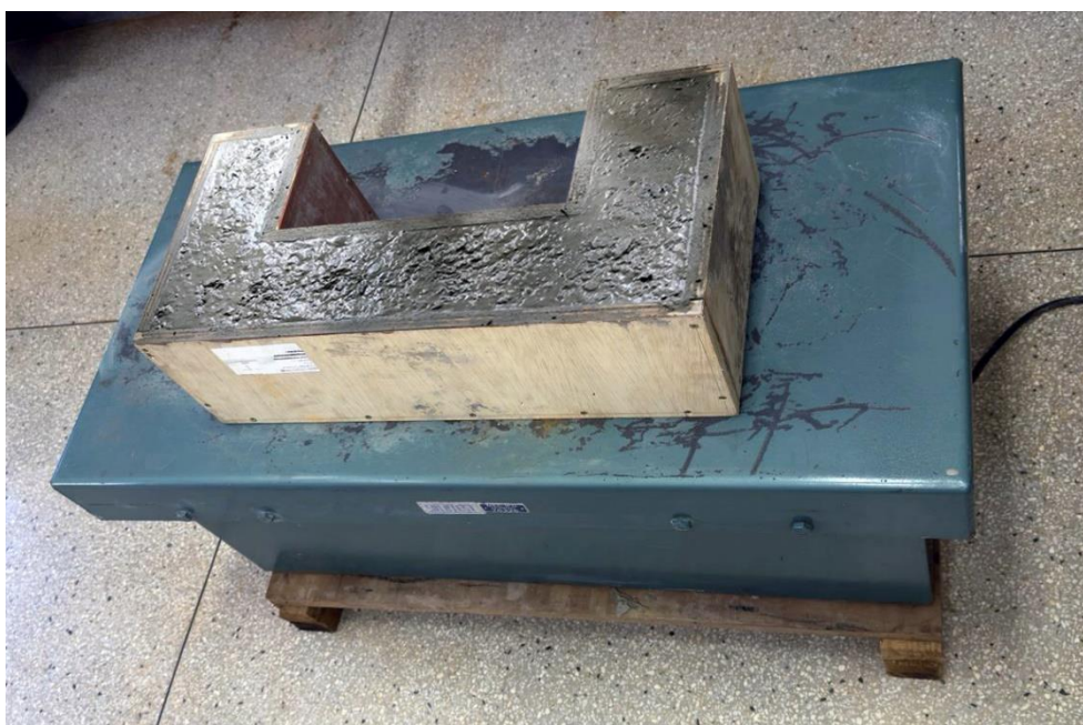
Figura 8 – Adensamento dos pilaretes em mesa vibratória.
