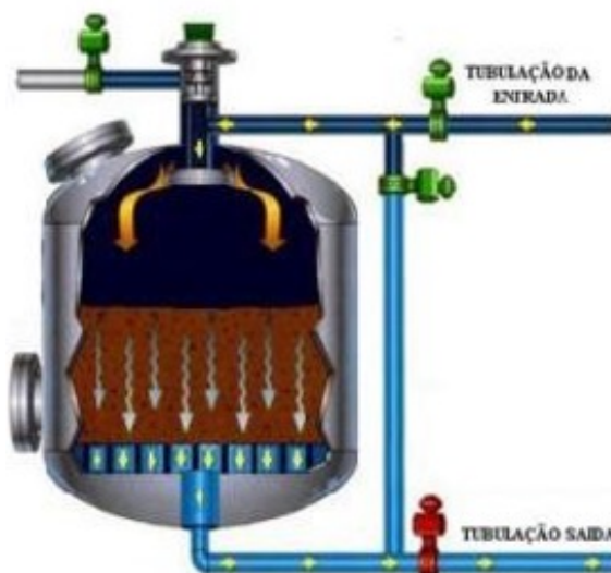
Figura 9 – Escoamento da água durante o processo de filtração no filtro de areia.
