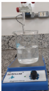
Figura 12 – Sistema experimental para síntese com adição de reagentes sob agitação magnética.
