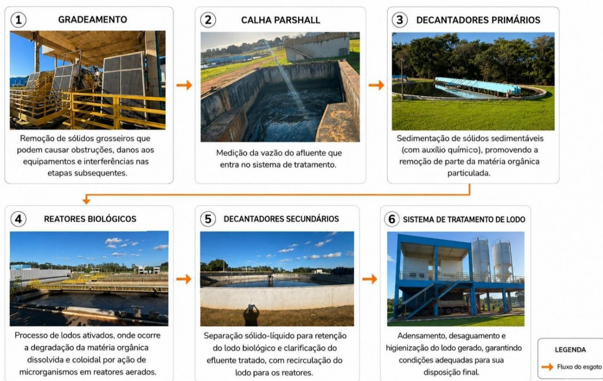
Figura 6 - Fluxograma de tratamento da ETE
