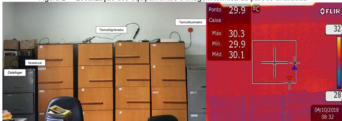
Figura 2 – Localização dos equipamentos e imagem térmica da parede analisada
