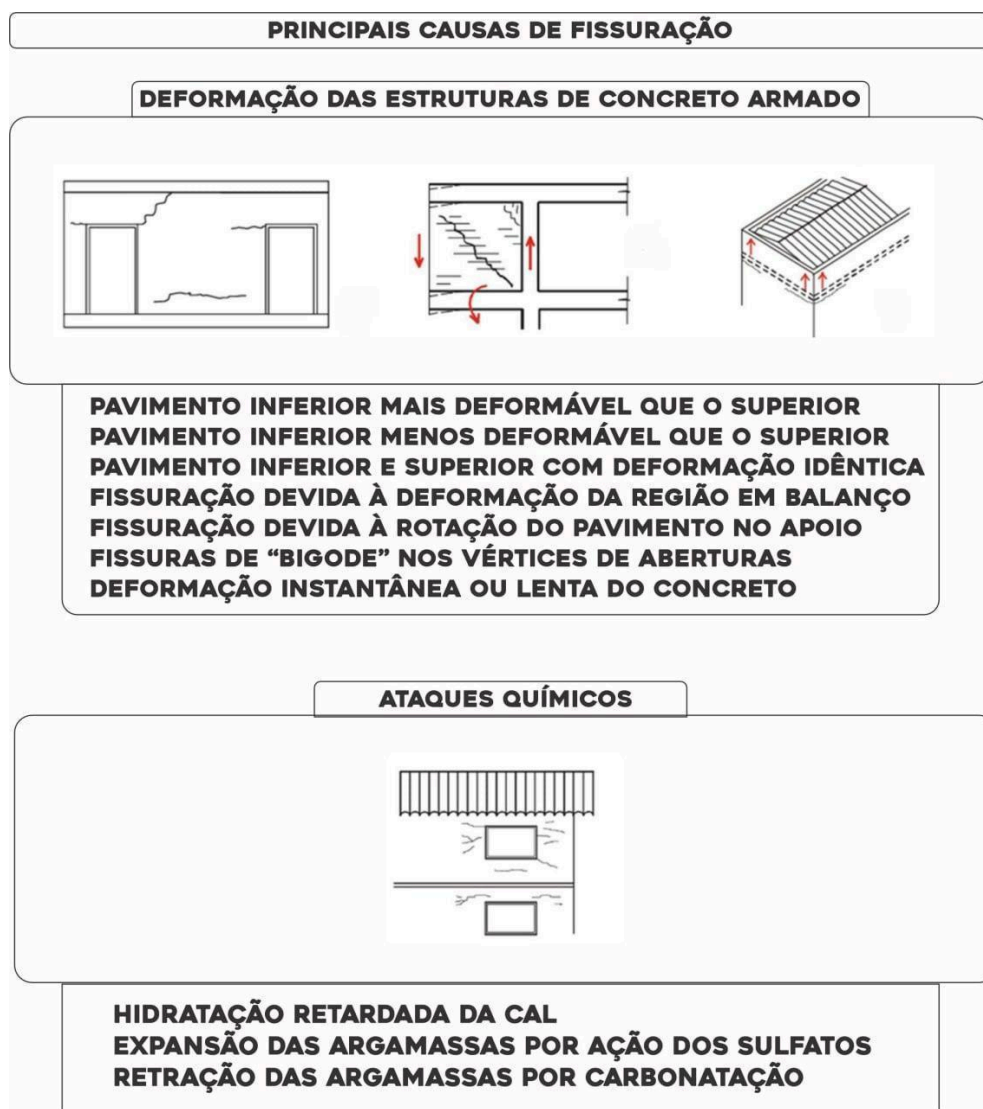
Figura 6 Principais Causas De Fissuras E Trincas
