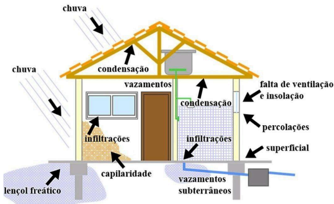
Figura 11 Principais Causas De Manchas Em Uma Edificação
