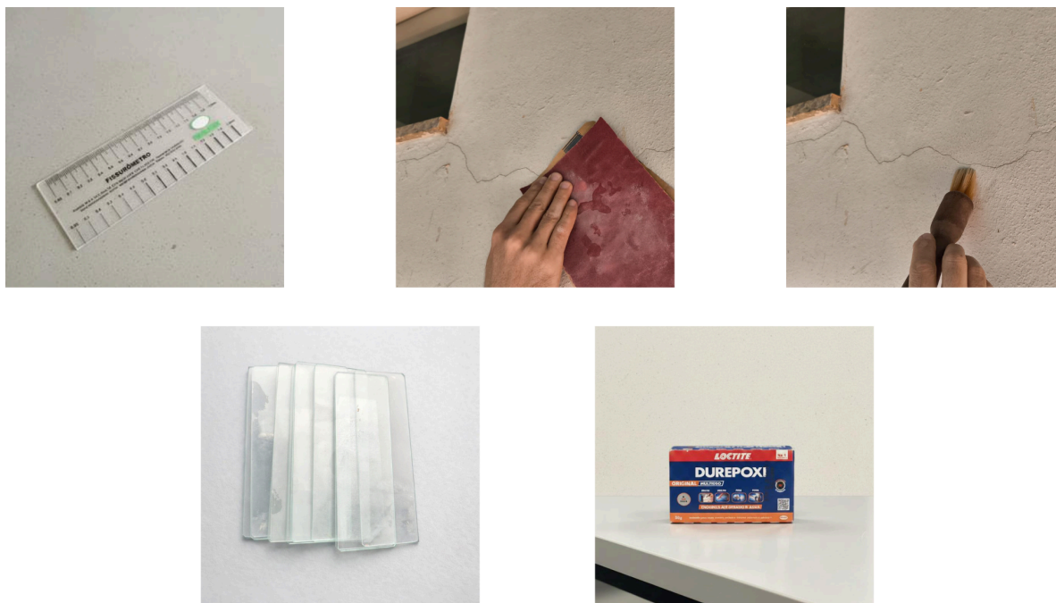
Figura 44 Materiais Utilizados Para O Ensaio De Trincas E Fissuras
