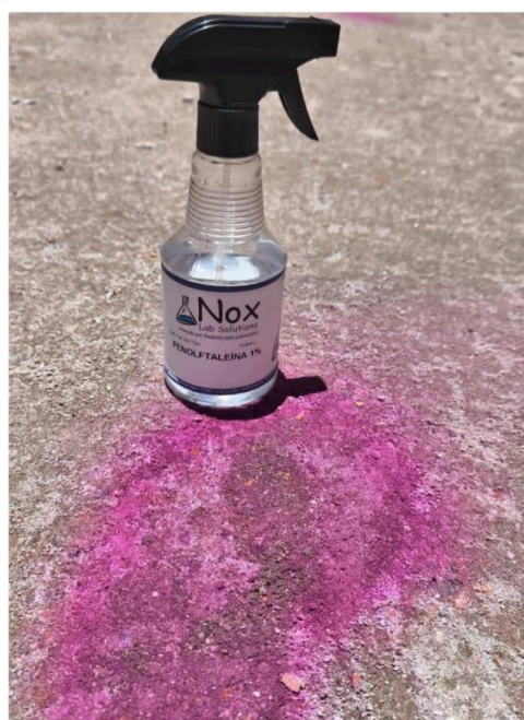
Figura 51 Ensaio De Carbonatação Com Fenolftaleína.
