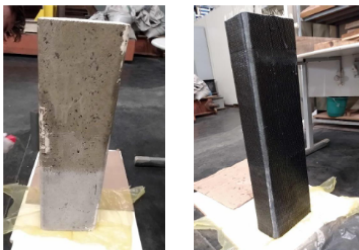
Figura 08 - Reforço de pilar com lâmina de fibras de carbono
