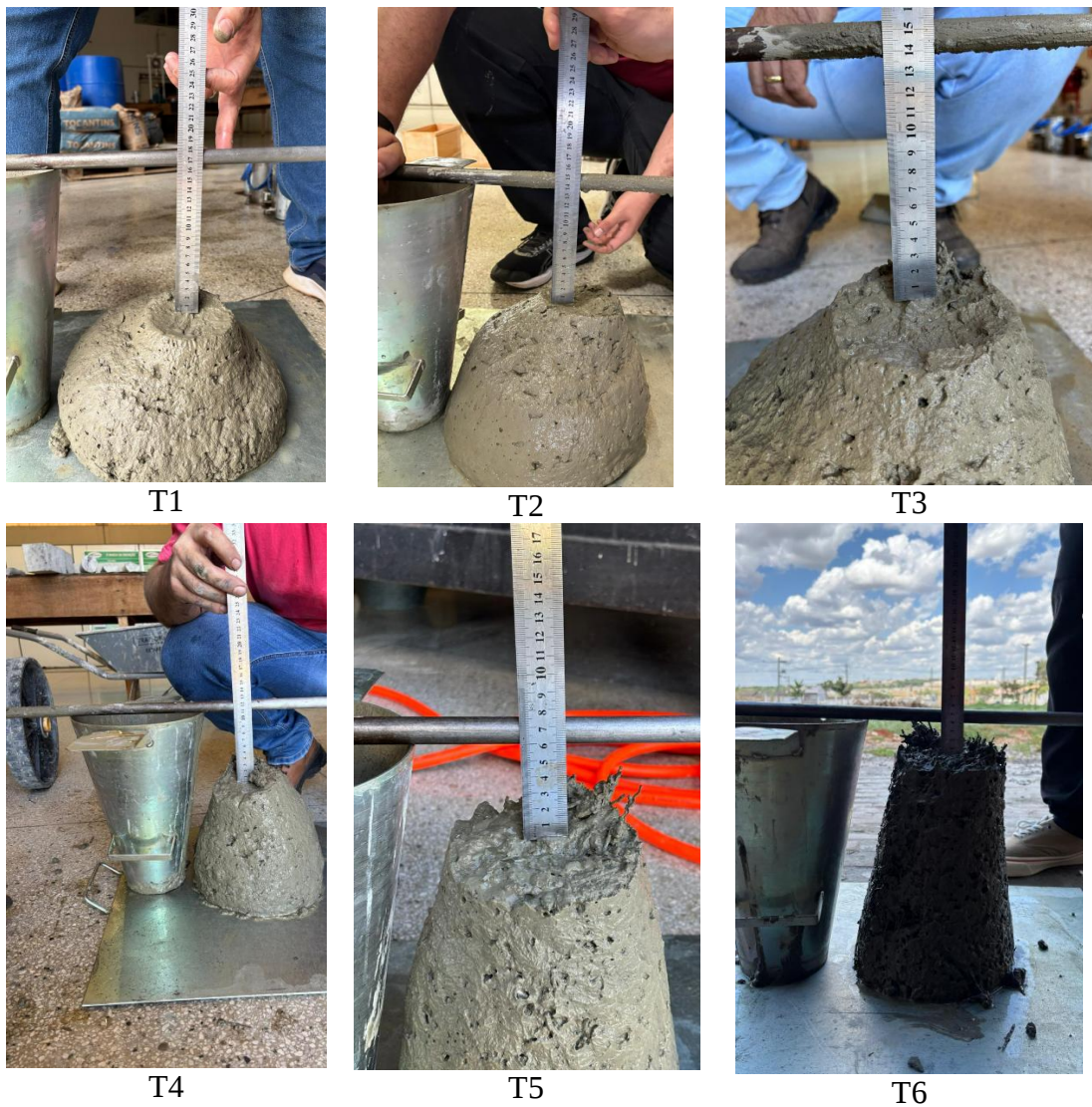
Figura 12 – Ensaio de abatimento do concreto (T1 a T6).
