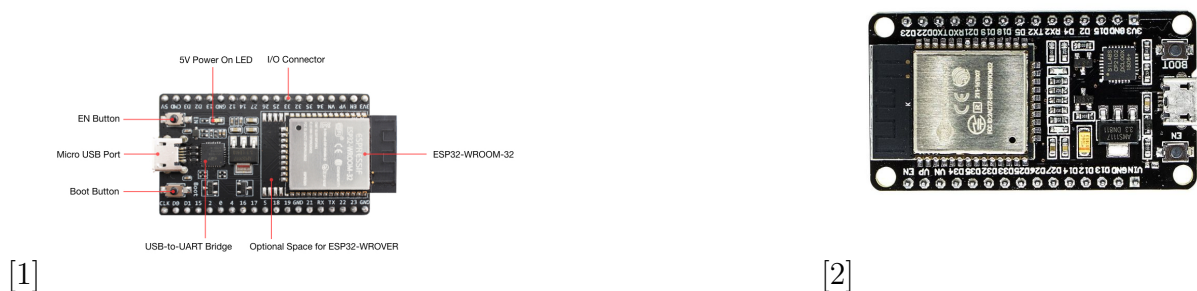
Figura 3 – 1) ESP32 DevKitC, 2) ESP32 DevKit. Fonte: Espressif.
