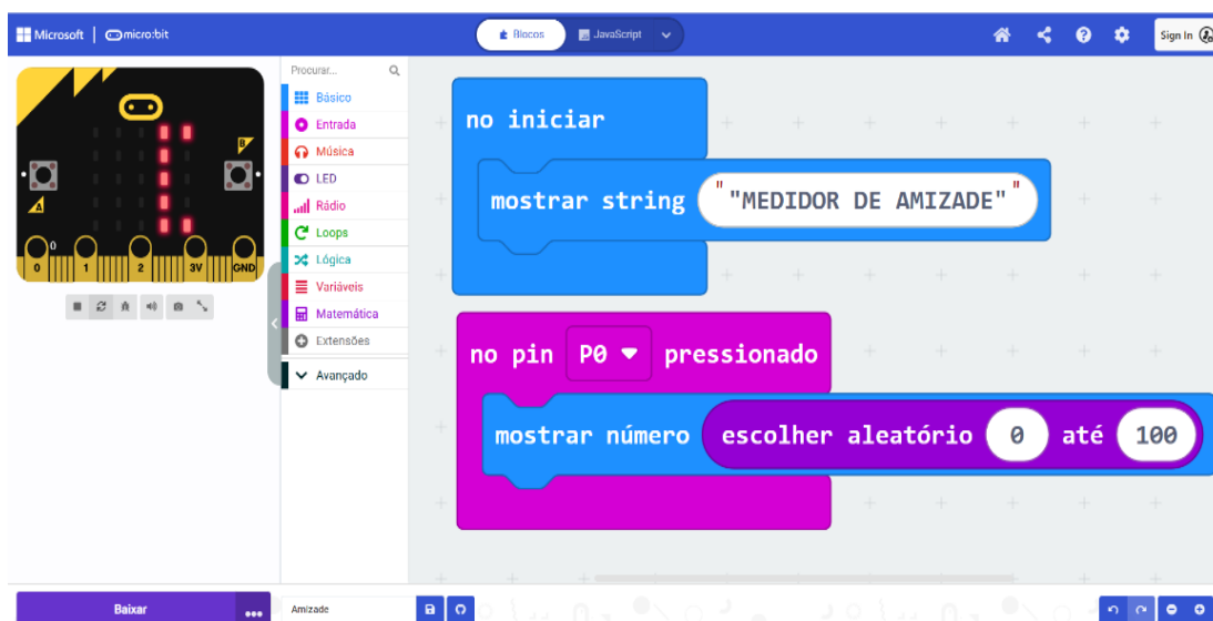
Figura 5 — Algoritmo do "Medidor do Nível de Amizade" estruturado no ambiente MakeCode Fonte: Do autor (2026).
