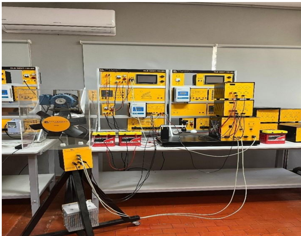
Figura 2: Planta de Energia Eólica em ambiente controlado
