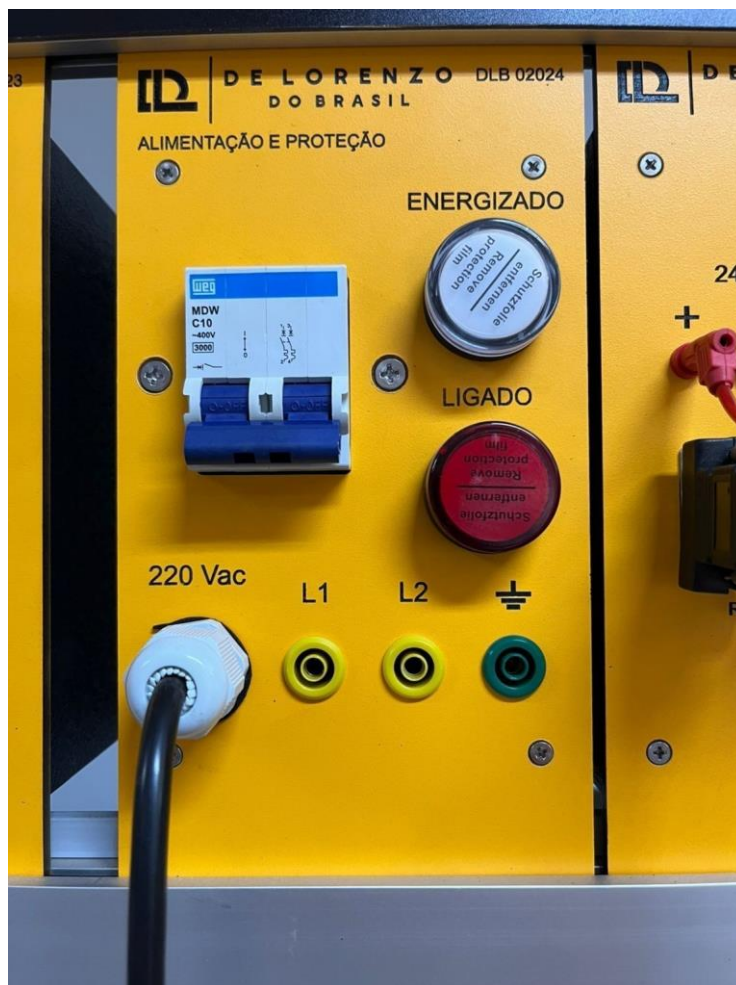
Figura 5: Pannel de alimentação e proteção elétrica
