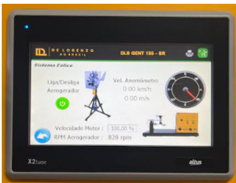
Figura 11 – Tela de controle do aerogerador com opções de ajuste de velocidade e estado de operação.
