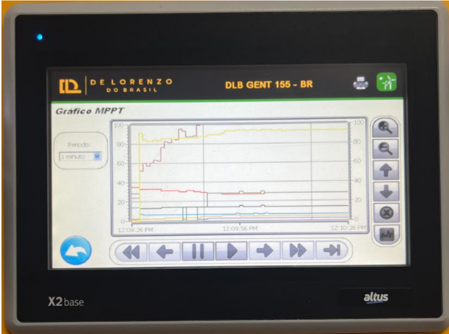
Figura 19 – Gráfico MPPT exibido na IHM para o Cenário 1, representando a variação de tensão, corrente e potência ao longo do tempo (1 minuto), com o aerogerador em 100% da velocidade.
