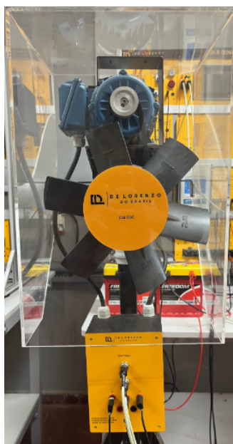
Figura 3 – Aerogerador da bancada didática DLB GENT-155-BR, utilizado para simulação de geração eólica em ambiente controlado.
