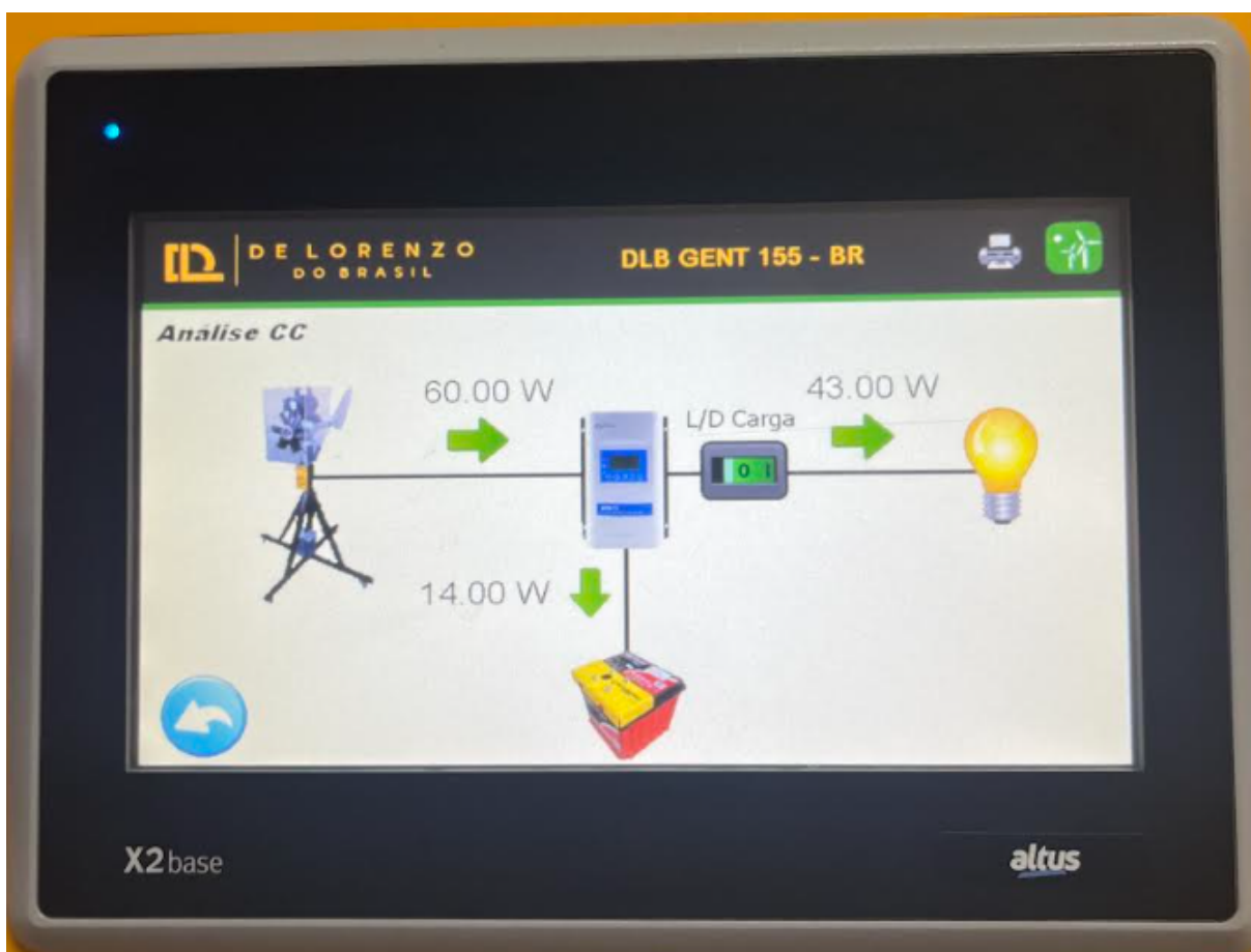
Figura 32 – Tela da IHM mostrando o fluxo de energia no modo estrela.
