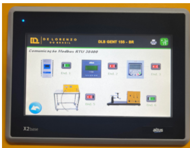
Figura 9 – Tela principal da IHM exibindo os módulos conectados via Modbus na bancada DLB GENT-155-BR.
