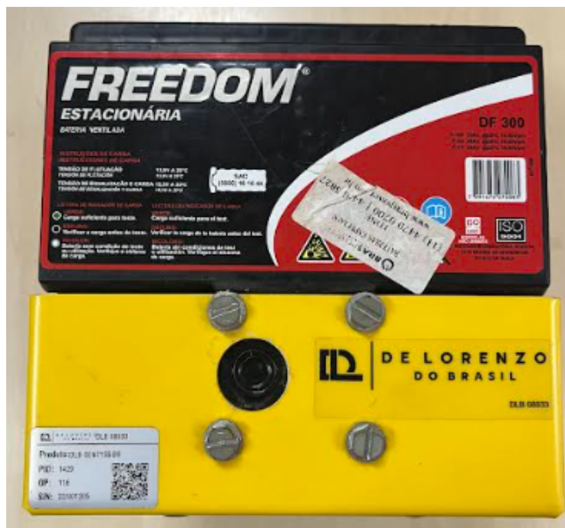
Figura 6 – Vista superior da bateria estacionária Freedom DF300 acoplada ao módulo DLB 08033 da bancada DLB GENT-155-BR.
