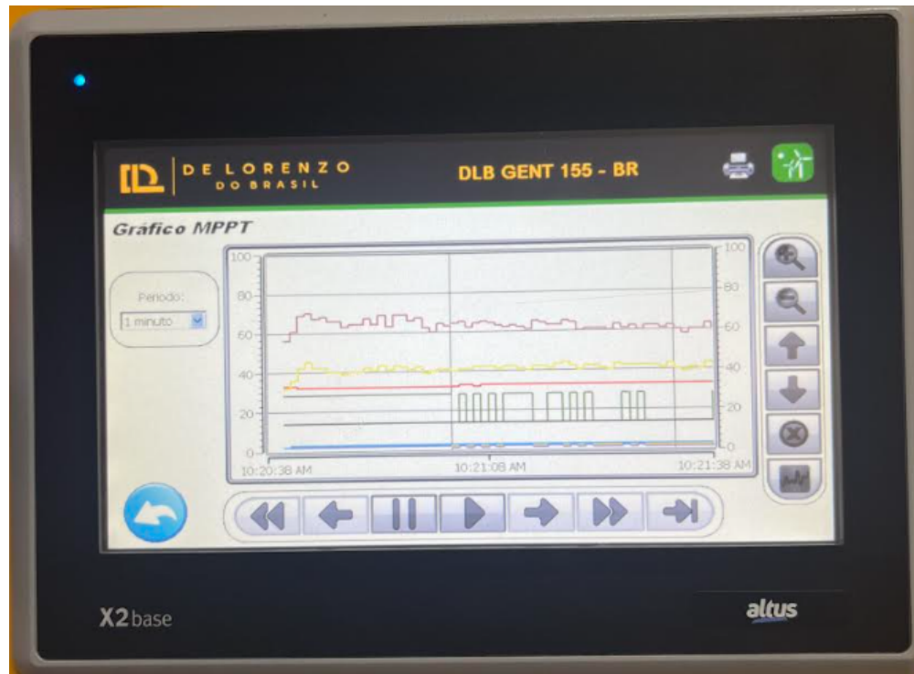
Figura 33 – Tela da IHM mostrando o gráfico MPPT no modo estrela.
