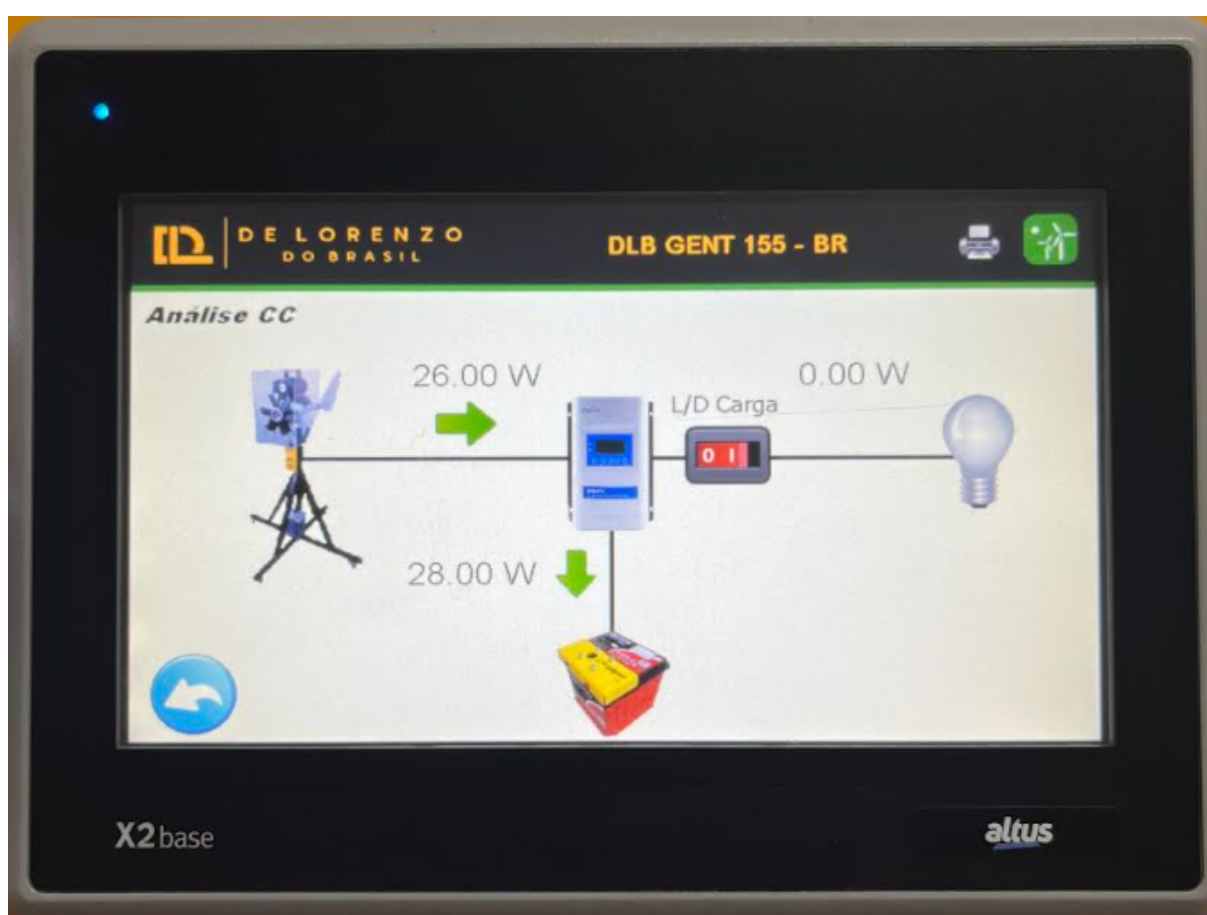
Figura 26 – Tela da IHM com ilustração do fluxo de energia do sistema para o Cenário 3, operando com o aerogerador em 100% da velocidade.
