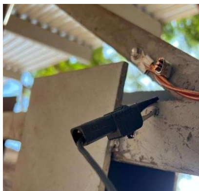
Figura 13 – Imagem anterior ampliada para garra de tomada de terra
