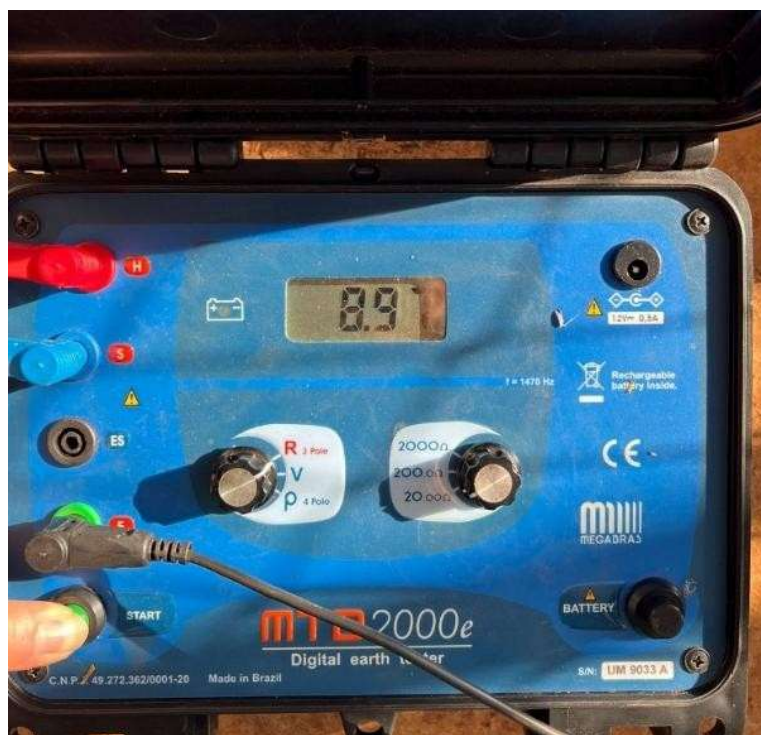
Figura 30: Medição realizada para verificação da execução da equipotencialização (visor terrômetro).
