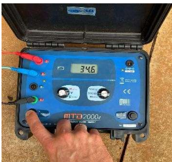
Figura 22 – Leitura terrômetro parte frontal
