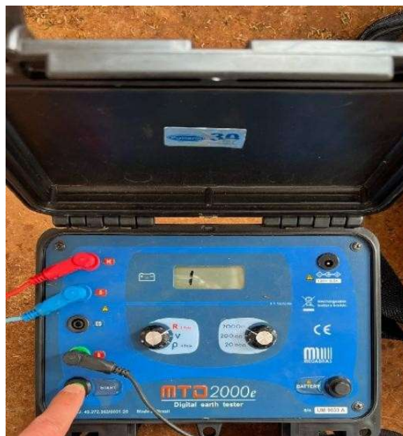
Figura 20 – Leitura terrômetro FS parte lateral
