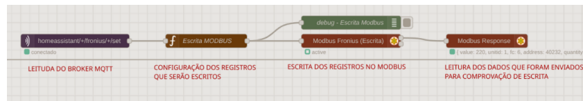
Figura 23 – Fluxos de escrita Modbus do inversor Fronius no Node-RED.
