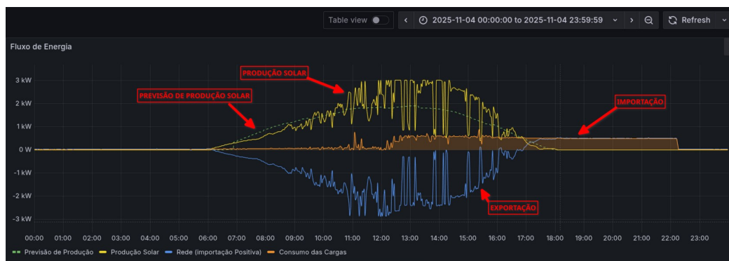
Figura 32 – Gráfico gerado no grafana para o dia 4 de novembro de 2025, com o sistema operando sem controle de potência ativo.
