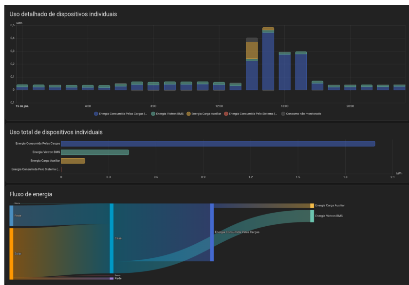
Figura 46 – Distribuição do consumo de energia por fonte e por dispositivo no dia 15/01/2026.
