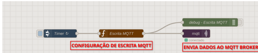
Figura 20 – Fluxos de escrita MQTT dos inversores do projeto no Node-RED.
