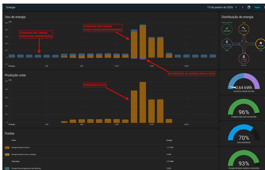
Figura 45 – Painel de energia do Home Assistant evidenciando exportações momentâneas durante a comutação da carga auxiliar (15/01/2026).
