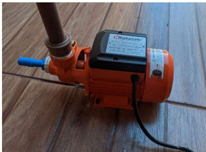
Figura 25 – Bomba periférica BP500 utilizada para transporte de água no sistema.
