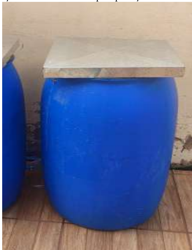
Figura 14 – Tampa em aço sobre o reservatório para proteção dos sensores e vedação do sistema.
