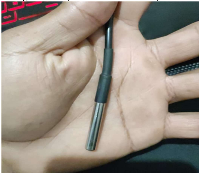
Figura 20 – Sensor digital de temperatura DS18B20 encapsulado utilizado no sistema.
