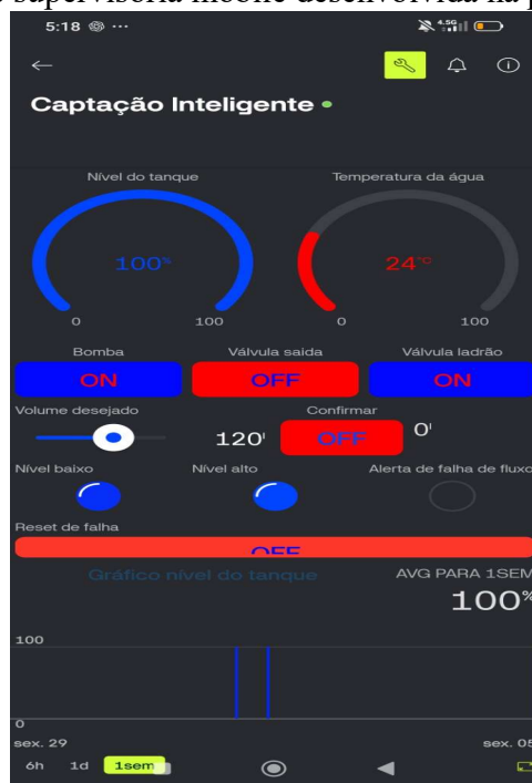
Figura 30 – Interface supervisória mobile desenvolvida na plataforma Blynk IoT.
