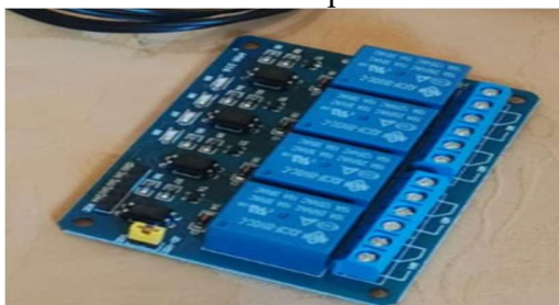
Figura 24 – Módulo de relés utilizado para acionamento dos atuadores.
