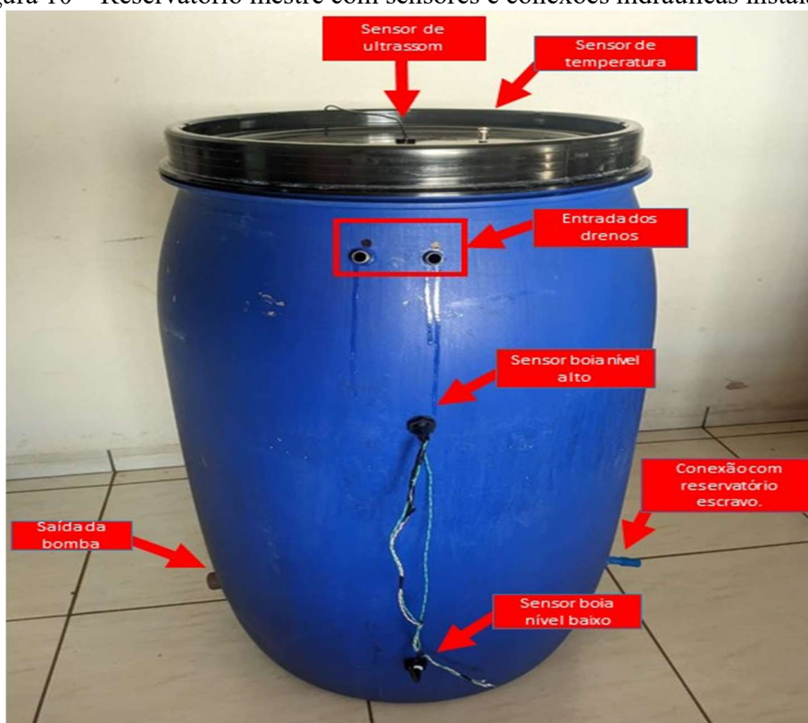
Figura 10 – Reservatório mestre com sensores e conexões hidráulicas instaladas.
