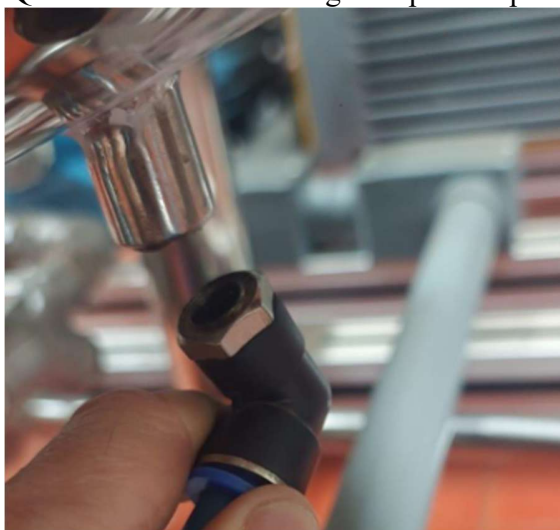
Figura 2 – Quebra da conexão de engate rápido da planta didática.
