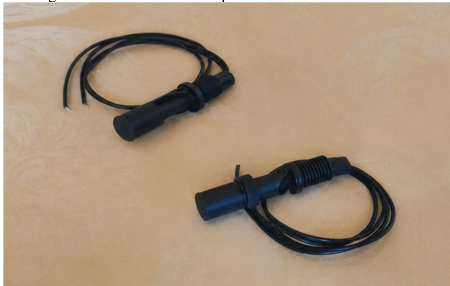
Figura 19 – Sensor de nível tipo boia horizontal utilizado no sistema.
