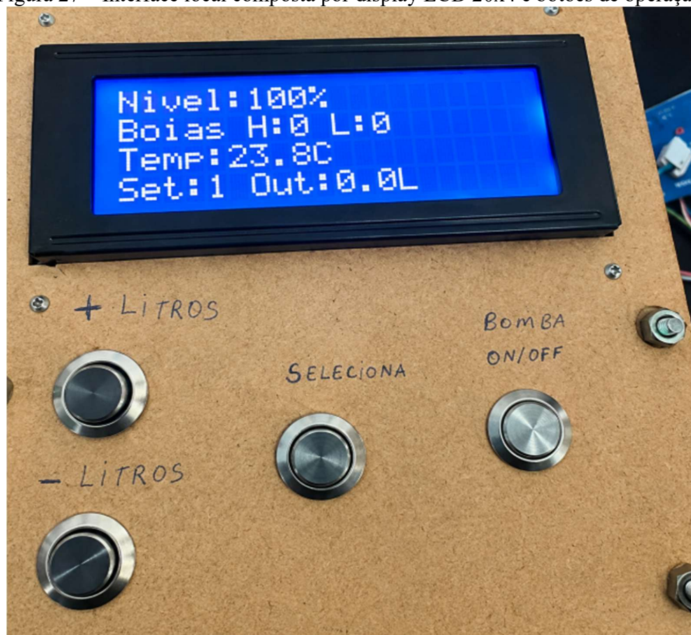
Figura 27 – Interface local composta por display LCD 20x4 e botões de operação.
