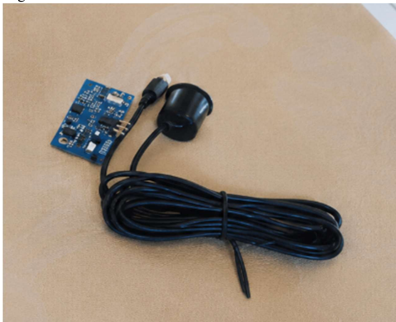
Figura 18 – Sensor ultrassônico AJ-SR04T utilizado no sistema.
