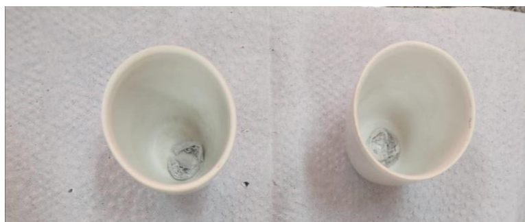
Figura 3 - Cinzas retiradas da mufla após 4 horas.
