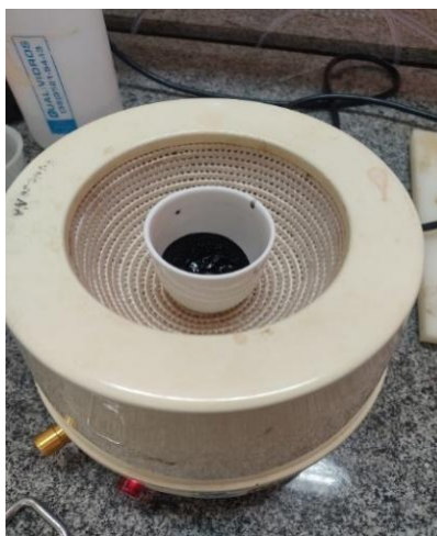
Figura 2- Amostra de trigo na chapa aquecedora para pré-digestão com \text{H}_2\text{SO}_4 , antes de ir a mufla.
