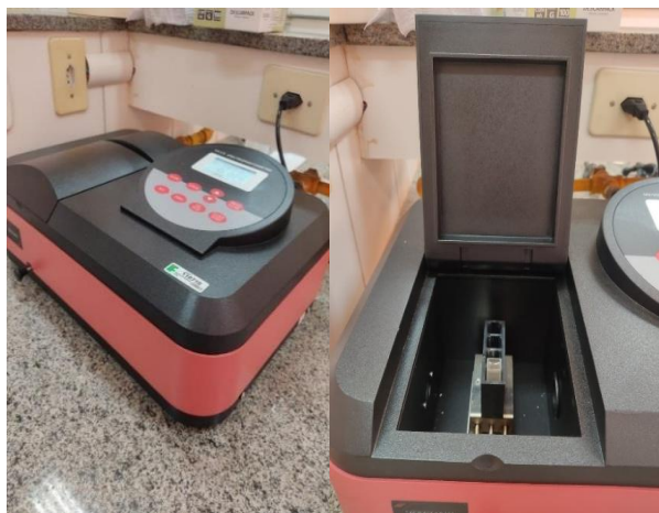
Figura 6 – Espectrofotômetro Kasuaki IL-593 usado nas medidas
