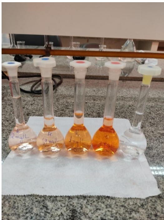
Figura 5 - Soluções preparadas para construção da curva de calibração.
