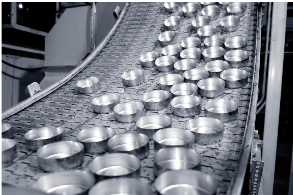
Figura 9 – Copo no transportador pressurizado. Fonte [3].
