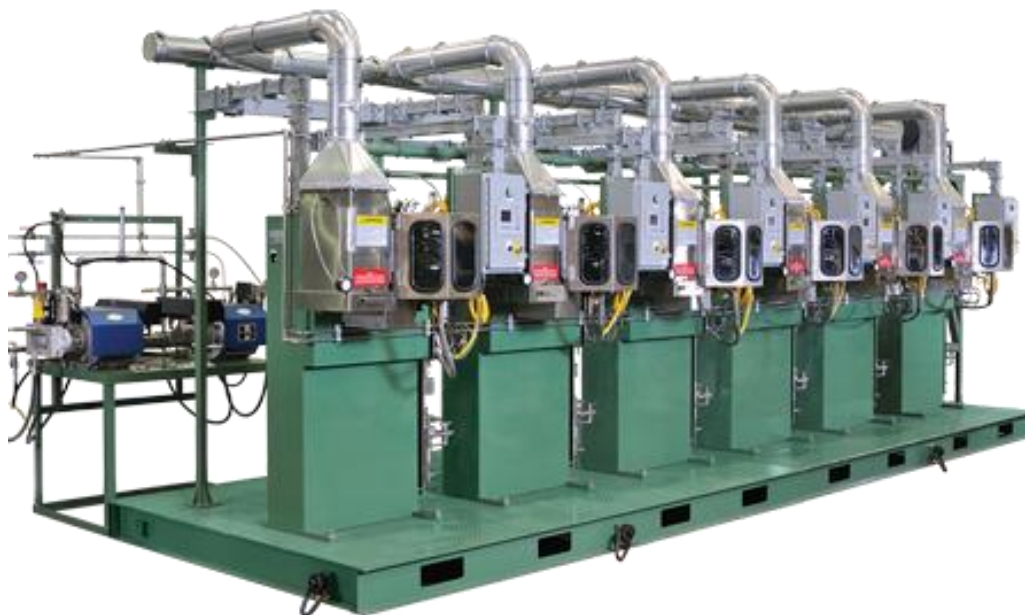
Figura 22 – Bancada de Aplicadores de Verniz. Fonte: [1].
