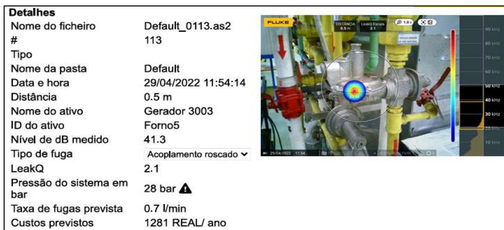
Figura 58 – Vazamento ar comprimido na mangueira da válvula. Fonte [Autor].
