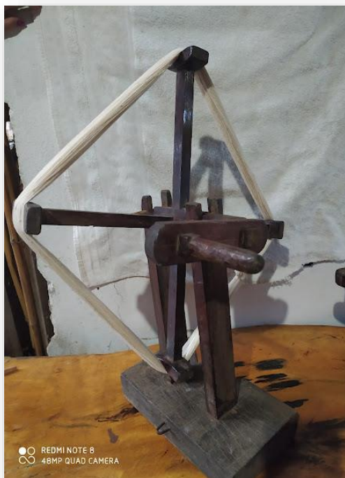
Figura 2 - Dobradeira com o fio dobrado em meada
