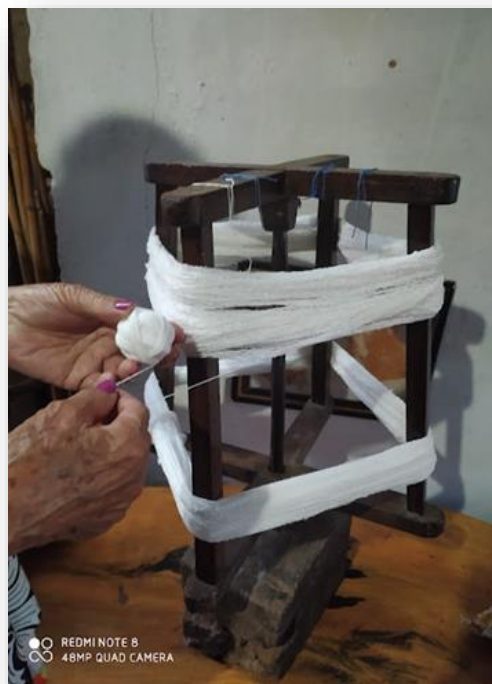
Figura 3 - Dobradeira com fio da meada sendo enovelado
