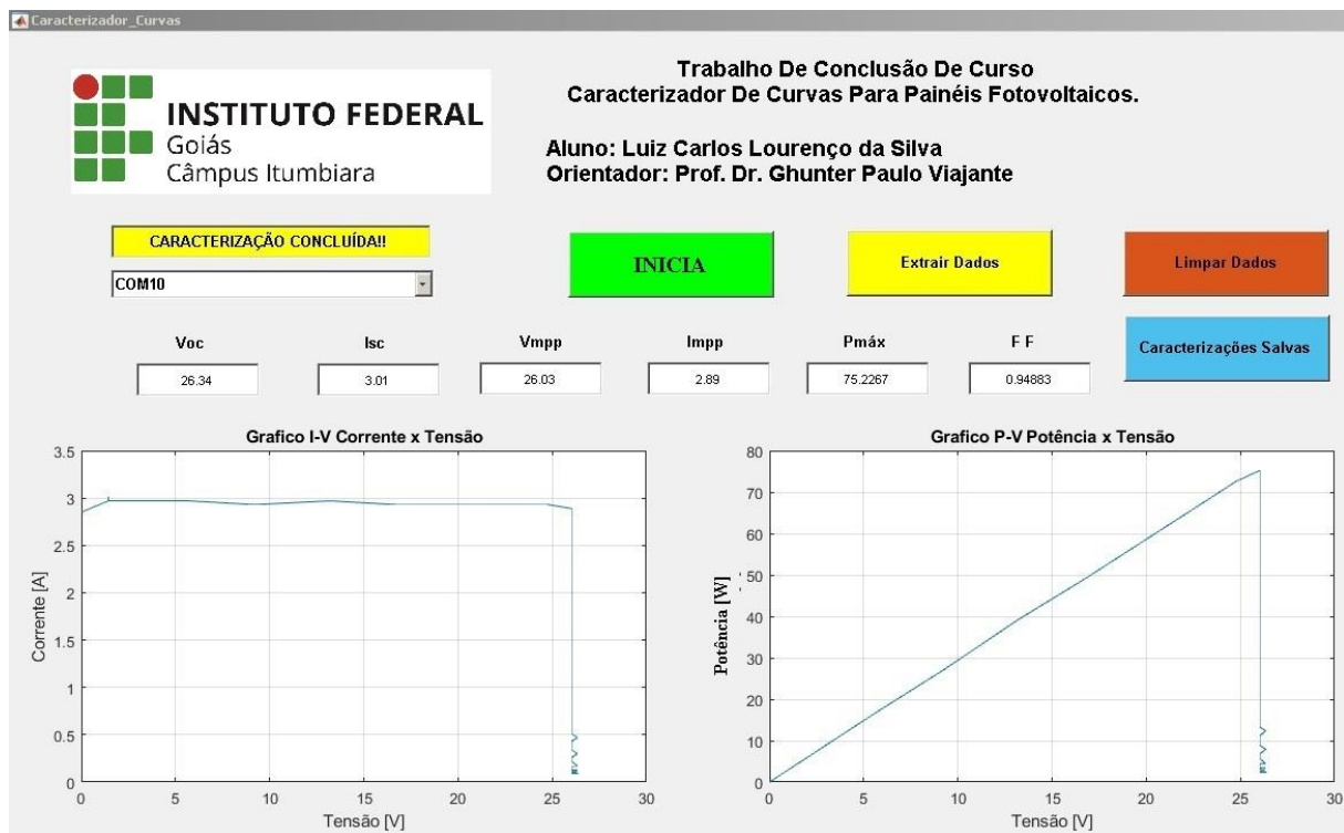
Figura 52 - Ensaio com a fonte de bancada ajustada em 25 Vcc. Fonte [Autor].
