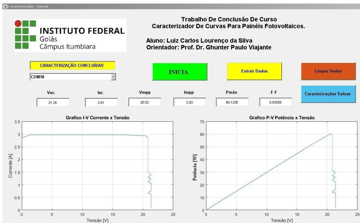
Figura 51 - Ensaio com a fonte de bancada ajustada em 20 Vcc. Fonte [Autor].
