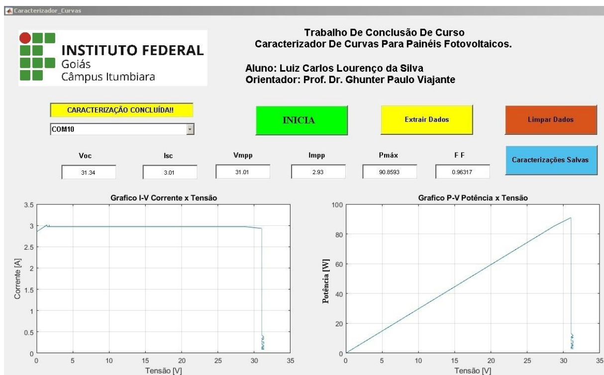
Figura 53 - Ensaio com a fonte de bancada ajustada em 30 Vcc. Fonte [Autor].
