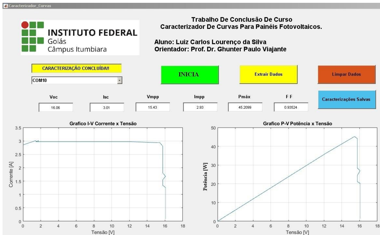
Figura 50 - Ensaio com a fonte de bancada ajustada em 15 Vcc. Fonte [Autor].
