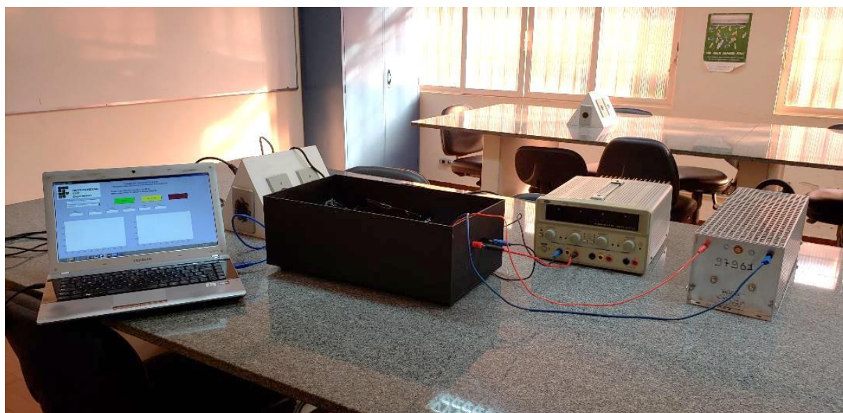
Figura 46 - Ensaio com a Fonte de Bancada Simulando um painel fotovoltaico. Fonte [Autor].
