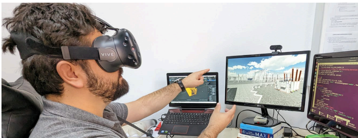
Figura 18 – Uso de óculos de realidade virtual com visualização do modelo BIM de uma subestação
