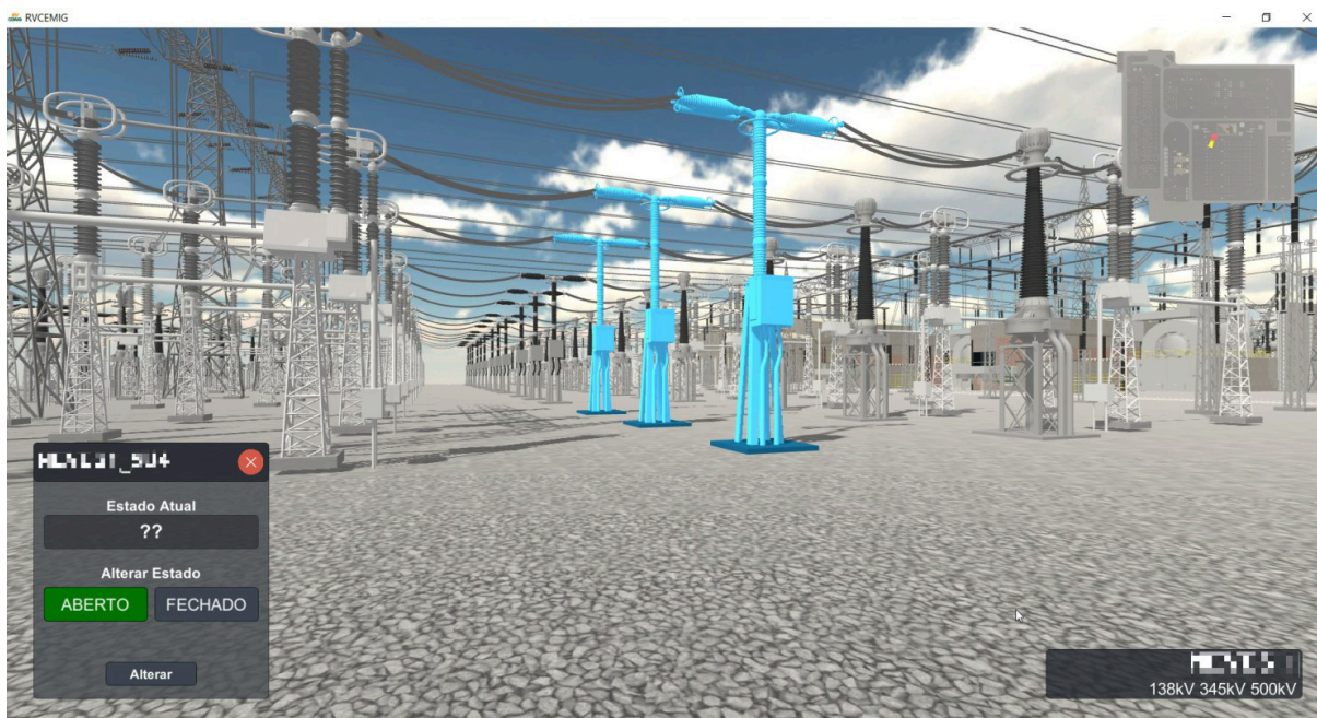
Figura 5 – Modelo BIM de uma subestação elétrica.
