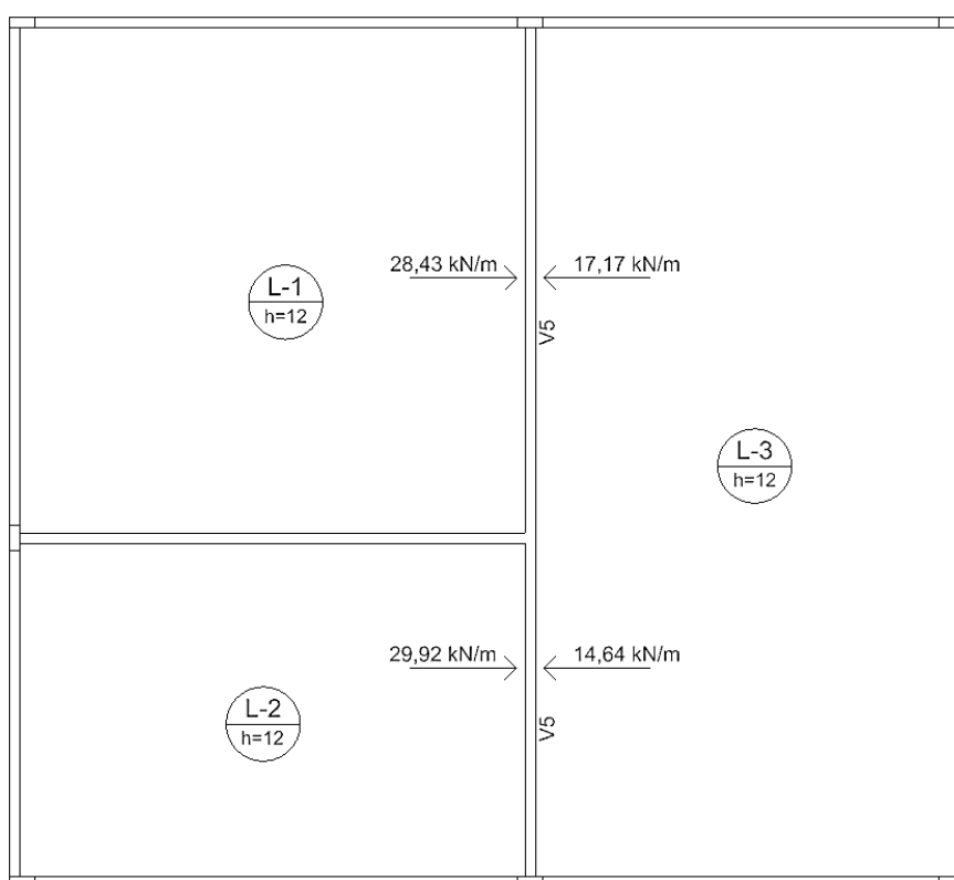
Figura 23 – Valores de reações das lajes na viga V5.
