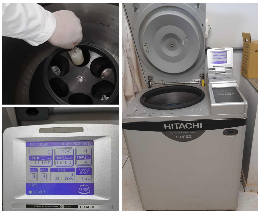
Figura 21: Separação da fase sólida na centrífuga (15.000 g a 4 °C por 15 minutos).
