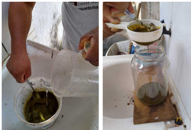
Figura 10: Diluição do inóculo com água 1/1 e peneiramento < 2mm.
