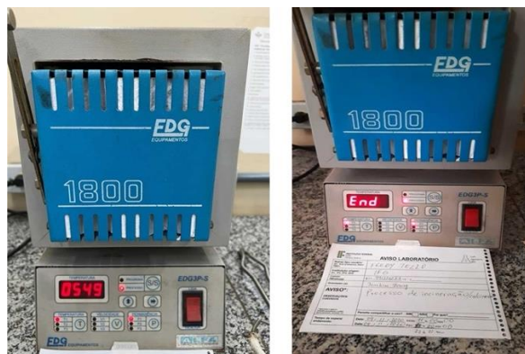
Figura A3- Calcinação completa da torta de filtro e de bagaço de cana de açúcar a 550°C por 4 horas.
