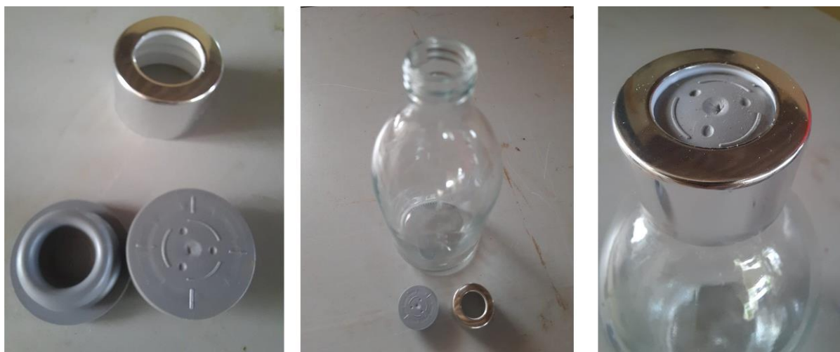
Figura 14- Reatores de 500 mL com tampa adaptada.
