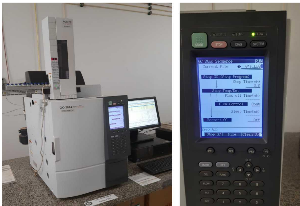
Figura 24 - Análise das amostras na Cromatografia Gasosa (GC), cromatógrafo Marca SHIMADZU, Modelo GC-2014, Serie C119451-00513, equipado com um detector de índice de refração RID-6A e uma coluna Nukleogel ION 300 OA com uma pré-coluna (Macherey-Nagel GmbH & Co. KG, Düren, Alemanha).
