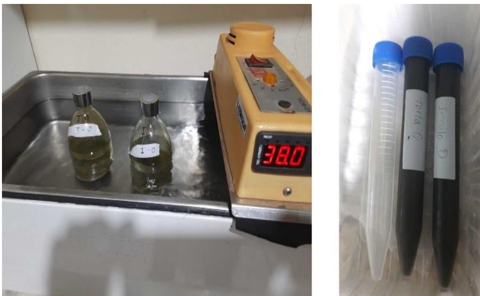
Figura A9- Reatores em banho maria a 38°C / Primeira coleta dia 0.
