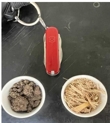
Figura A2- Calcinação inicial da torta de filtro e de bagaço de cana de açúcar.
