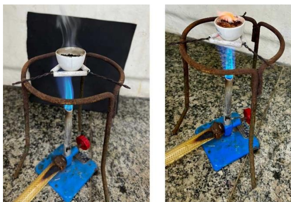
Figura A2- Calcinação inicial da torta de filtro e de bagaço de cana de açúcar.
