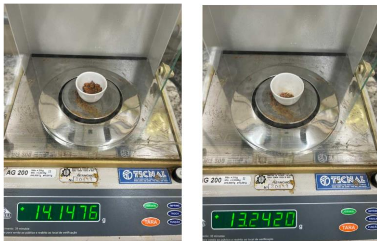
Figura A4- Determinação de massa seca inorgânica (cinzas) da torta de filtro e do bagaço de cana de açúcar após a calcinação.
