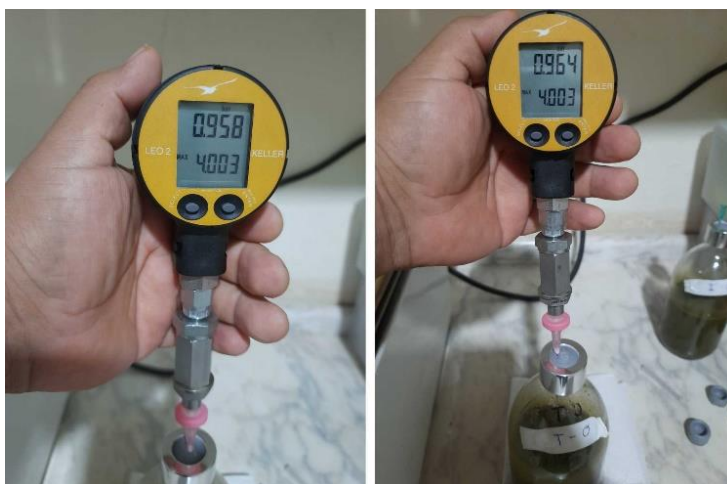
Figura A11- Última Coleta de dados (Pressão do reator com Inoculo e Torta de filtro).
