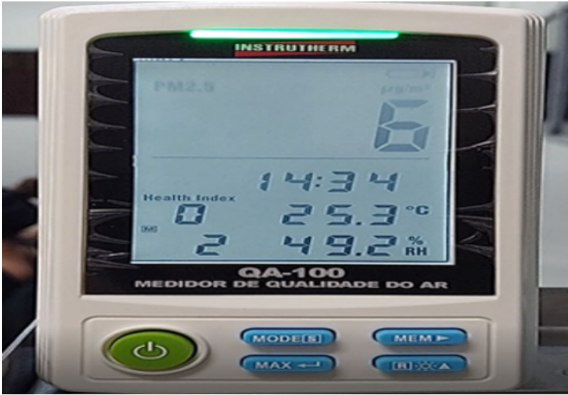
Figura 7 – Instrumental 1 utilizado na avaliação de umidade e temperatura do ar
