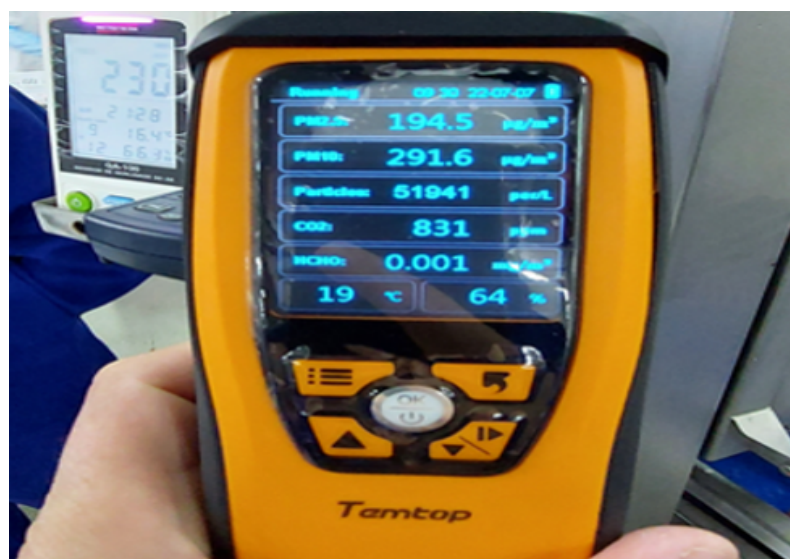
Figura 8 – Instrumental 2 utilizado na avaliação de umidade e temperatura do ar
