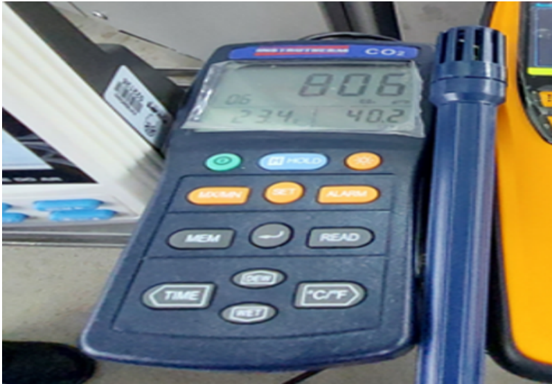
Figura 6 – Instrumental 2 utilizado na avaliação de CO 2
