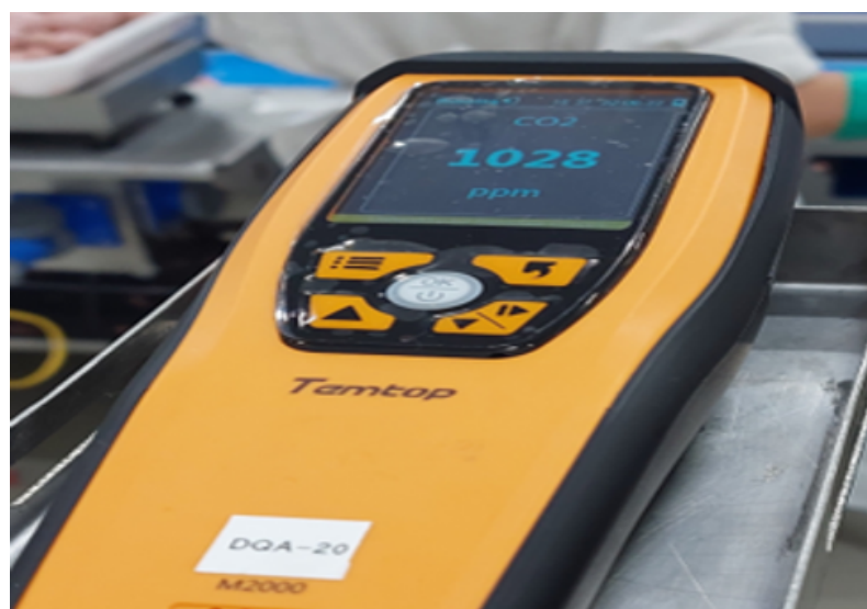
Figura 5 – Instrumental 1 utilizado na avaliação de CO 2
