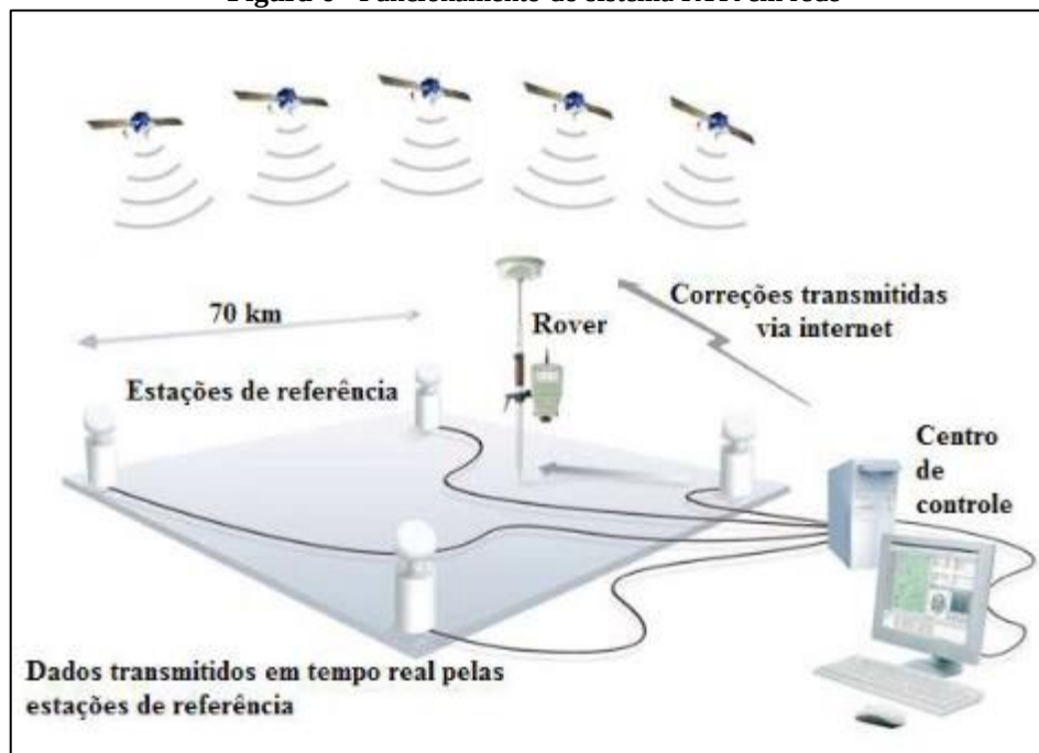
Figura 6 - Funcionamento do sistema RTK em rede
