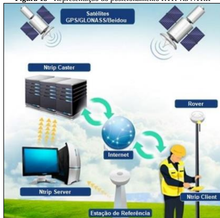
Figura 18 - Representação do posicionamento RTK via NTRIP
