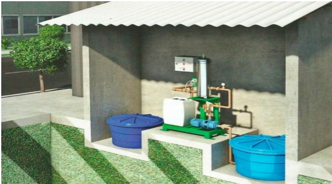
Figura 12: Sistema de bombeamento de água da chuva
