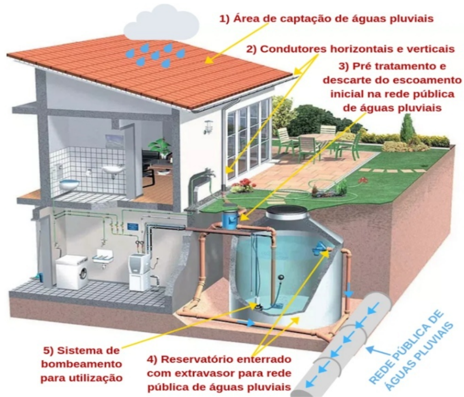
Figura 8 – Sistema de captação e aproveitamento de águas pluviais
