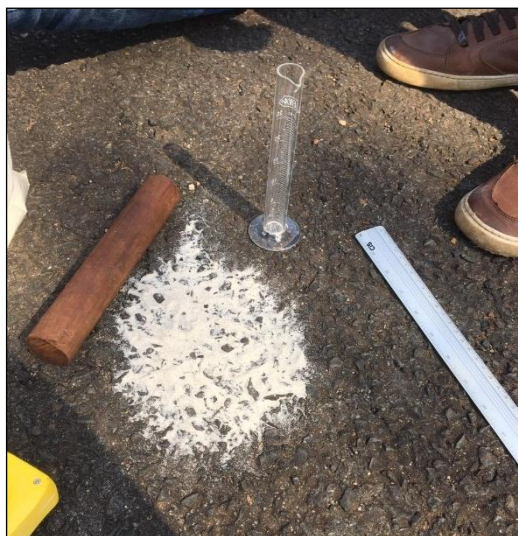
Figura 4. 6 – Ensaio de Mancha de Areia in loco
