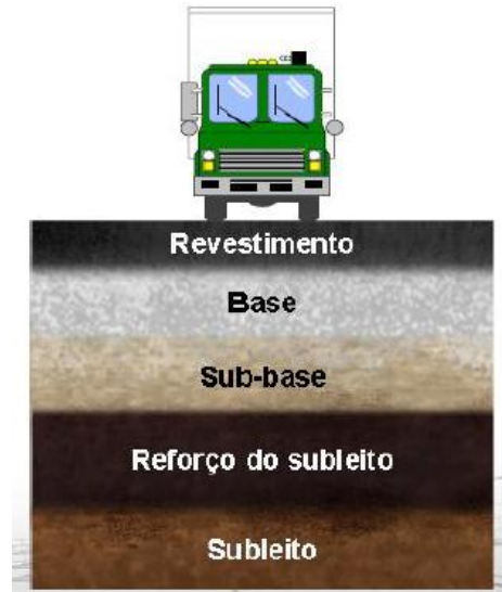
Figura 1.4 – Camadas do pavimento flexível
