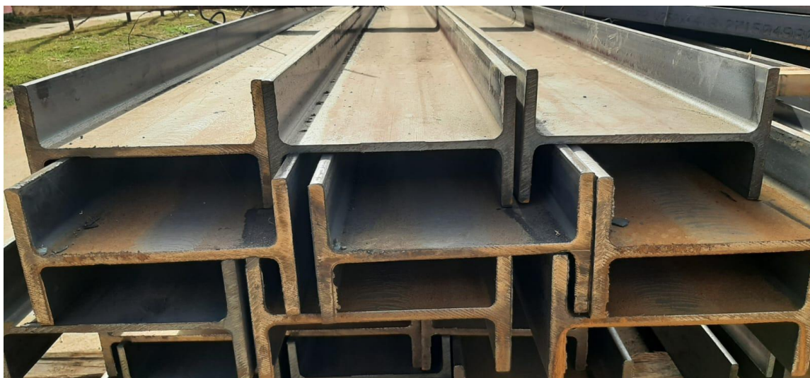
Figura 3.16 - Perfis metálicos da série W armazenados em obra
