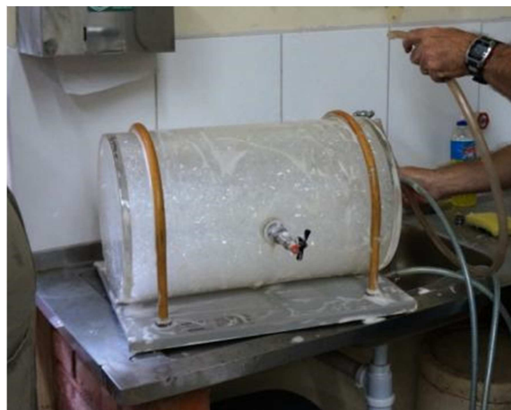
Figura 3.13 – Limpeza do tanque desaerador.
