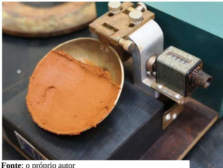
Figura 3.15 – Realização do ensaio de limite de liquidez.
