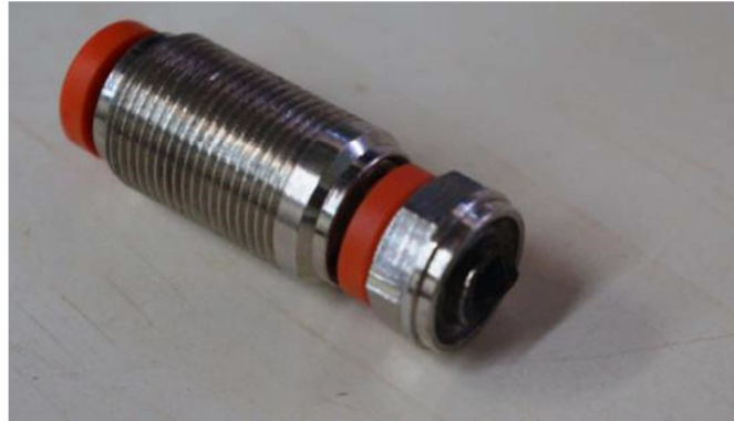
Figura 3.27 – Engate rápido rompido do manômetro
