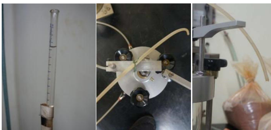
Figura 3.20 – Da esquerda para direita: detalhe da bureta preenchida com água, configuração da ligação do dreno, detalhe do dreno.
