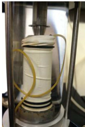
Figura 3.19 – Corpo de prova já posicionado na célula triaxial preenchida com água.
