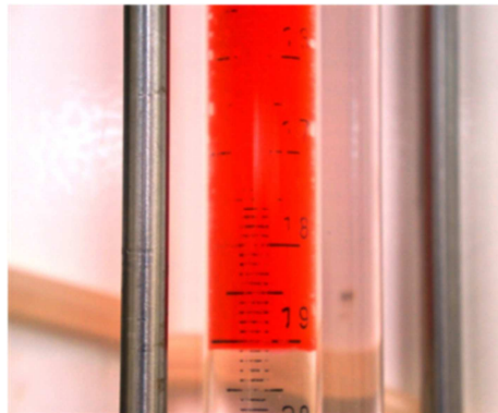
Figura 3.28 – Detalhe do desgaste da bureta do variômetro
