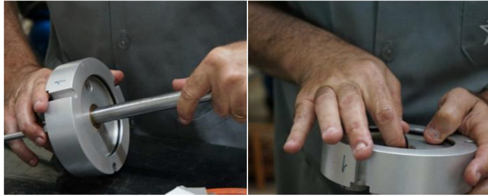
Figura 3.8 – Substituição de oringue “estrangulado” e recolocação do pistão na tampa superior da célula.
