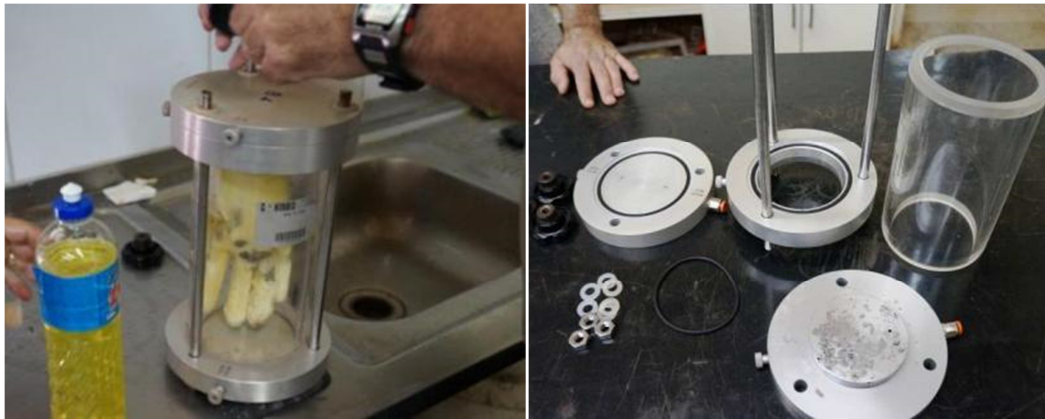
Figura 3.2 – Manutenção das células de aplicação de pressão constante: A esquerda, desmontagem da célula para desobstrução das entradas, limpeza e troca da membrana ou luva; a direita, componentes da célula já limpos aguardando montagem
