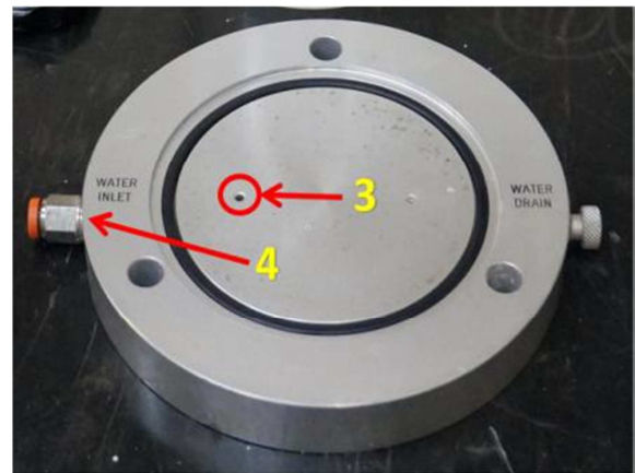
Figura 3.4 – Da esquerda para direita respectivamente; Base e Topo da célula de aplicação de pressão constante. As setas (1) e (4) indicam os engates rápidos; (2) e (3) os orifícios.
