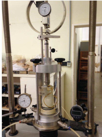
Figura 3.25 – Corpo de prova em ensaio na prensa do IFG - Campus Goiânia
