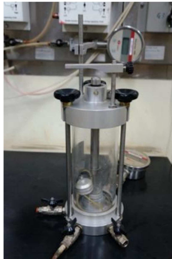
Figura 3.7 – Célula triaxial de ensaios.
