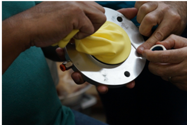
Figura 3.3 – Substituição da luva ou membrana da célula de aplicação de pressão constante.
