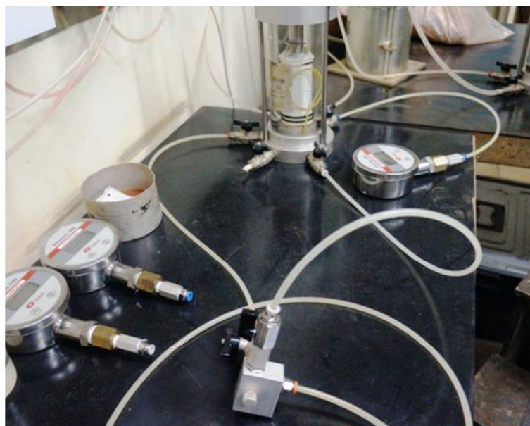
Figura 3.21 – Detalhe da ligação da execução da etapa de contra pressão.
