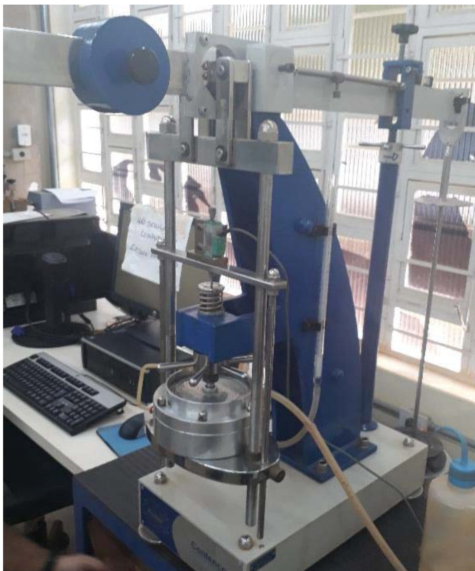
Figura 3.2.3.1. Célula de adensamento montada no equipamento.
