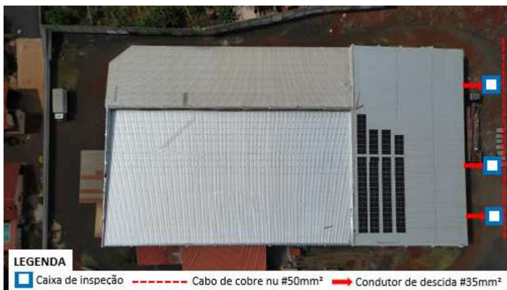
Figura 33 - Sistemas de Descida e Aterramento do Galpão
