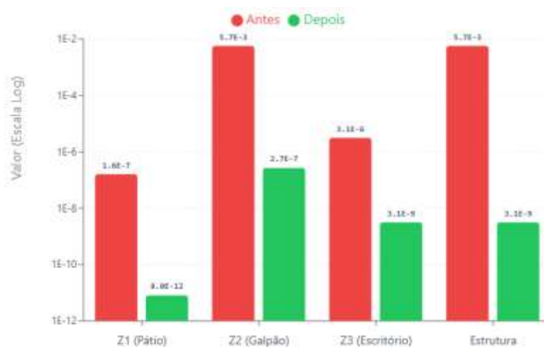
Figura 42 – Comparativo entre antes e depois das correções e melhoras no SPDA
