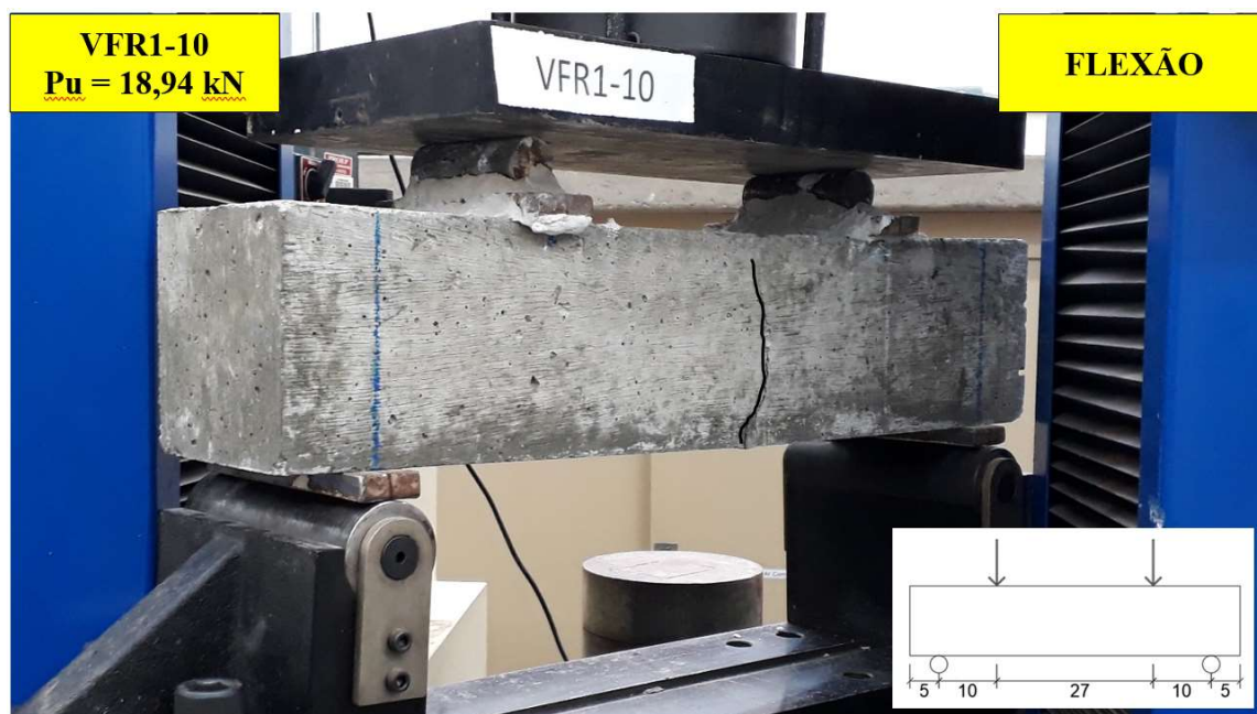
Figura 4.16 – Carga e modo de ruptura da viga VFR1-10
