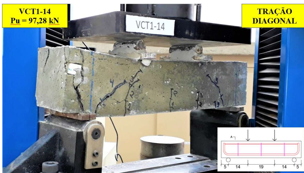
Figura 4.20 – Carga e modo de ruptura da viga VCT1-14
