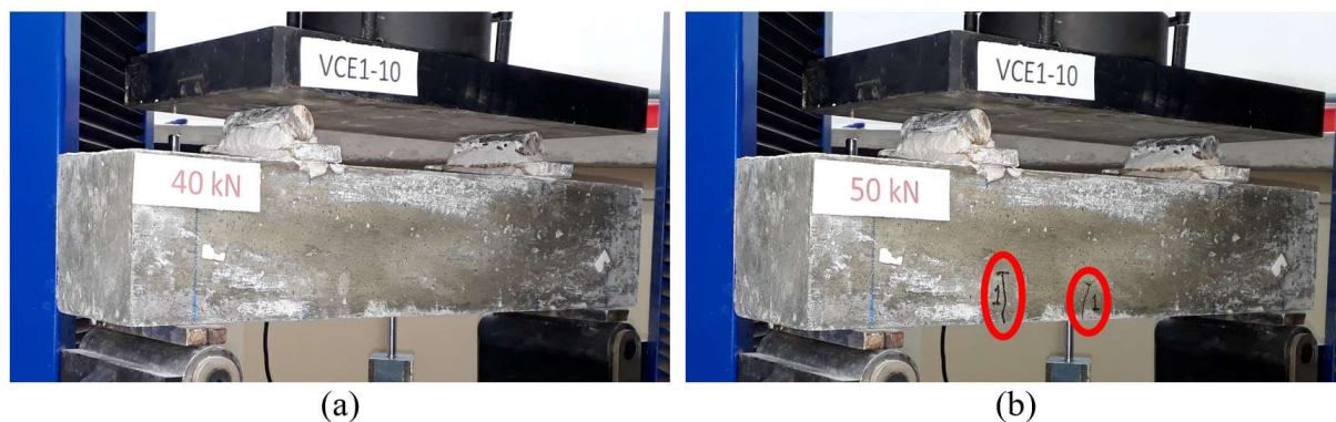
Figura 4.14 – Desenvolvimento de fissuras na viga VCE1-10
