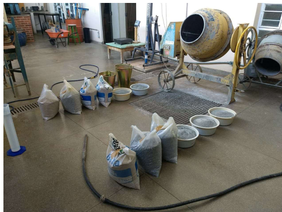
Figura 3.4 – Separação dos materiais para a concretagem
