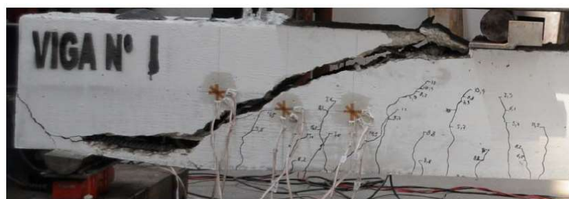
Figura 2.33 - Viga I – Ruptura pelos estribos
