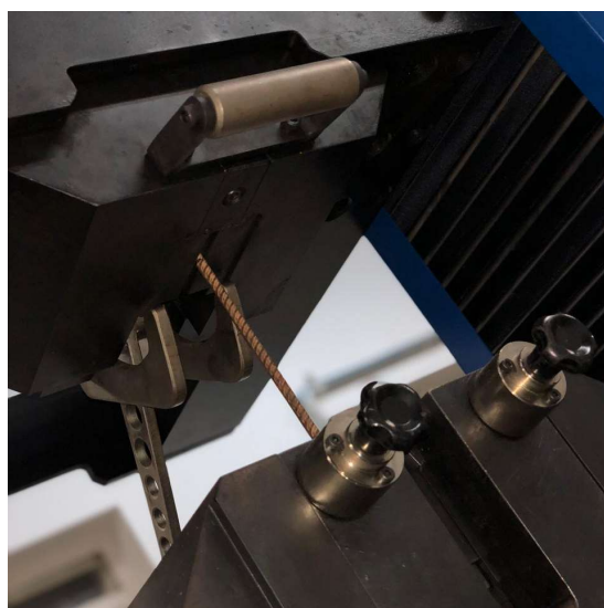
Figura 3.3 – Ensaio de tração nas barras de aço
