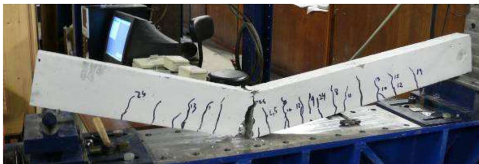
Figura 2.24 - Viga apoiada – Tipologia 1
