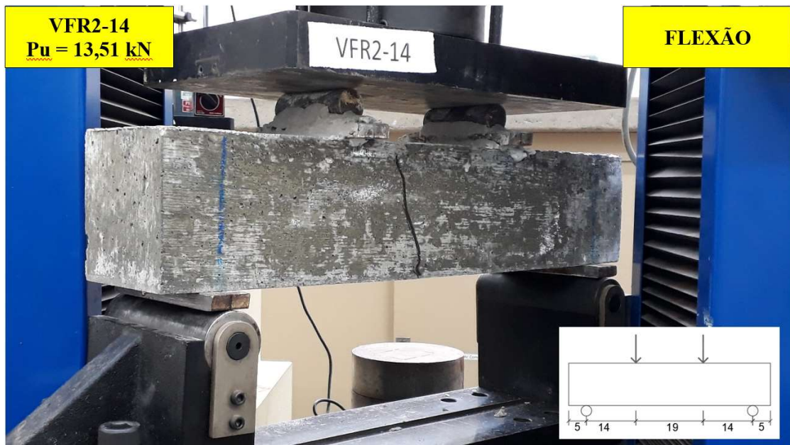
Figura 4.17 – Carga e modo de ruptura da viga VFR2-14
