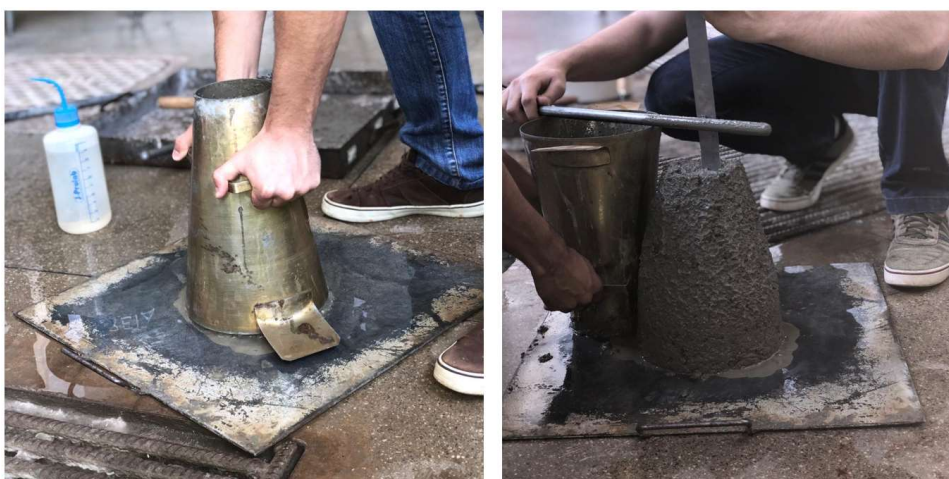
Figura 3.7 – Ensaio de abatimento do tronco de cone
