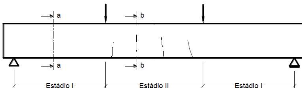
Figura 2.3 - Viga no Estádio II de Carregamento
