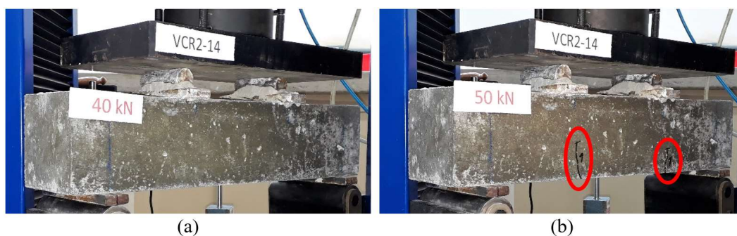
Figura 4.11 - Desenvolvimento de fissuras na viga VCR2-14
