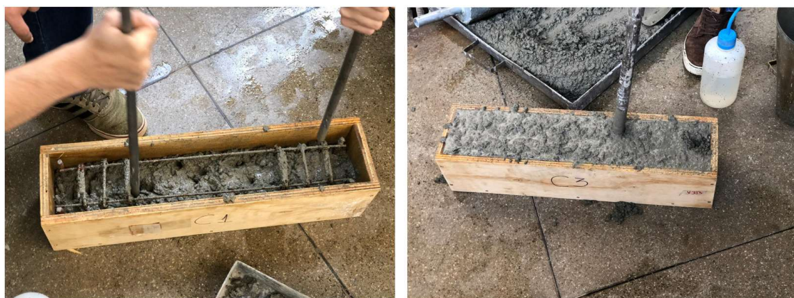
Figura 3.8 – Adensamento das vigas
