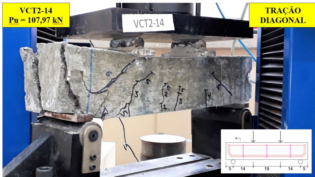
Figura 4.21 – Carga e modo de ruptura da viga VCT2-14
