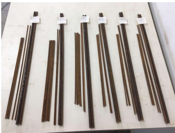
Figura 3.5 – Barras cortadas e separadas para armação
