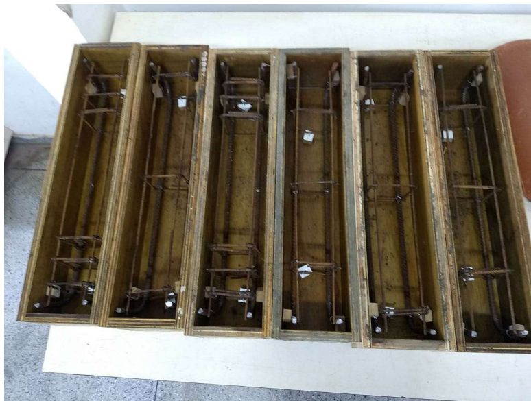
Figura 3.6 – Posicionamento da armadura dentro das formas
