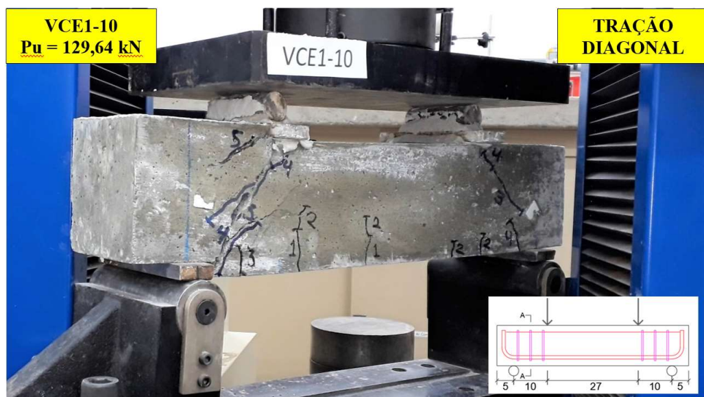
Figura 4.22 – Carga e modo de ruptura da viga VCE1-10
