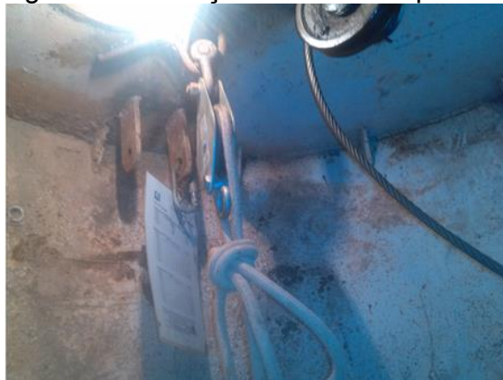
Figura 3.2 - Fixação do cabo acoplado à campânula
