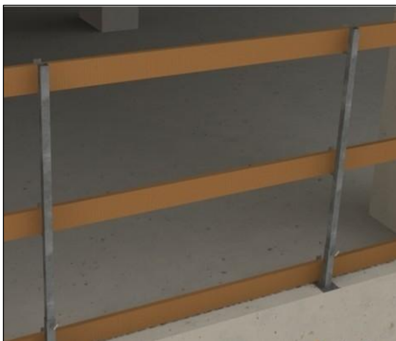
Figura 18 - Exemplo para guarda corpo
