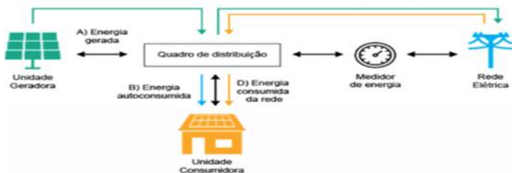
Figura 11: Distribuição de energia de forma descentralizada.
