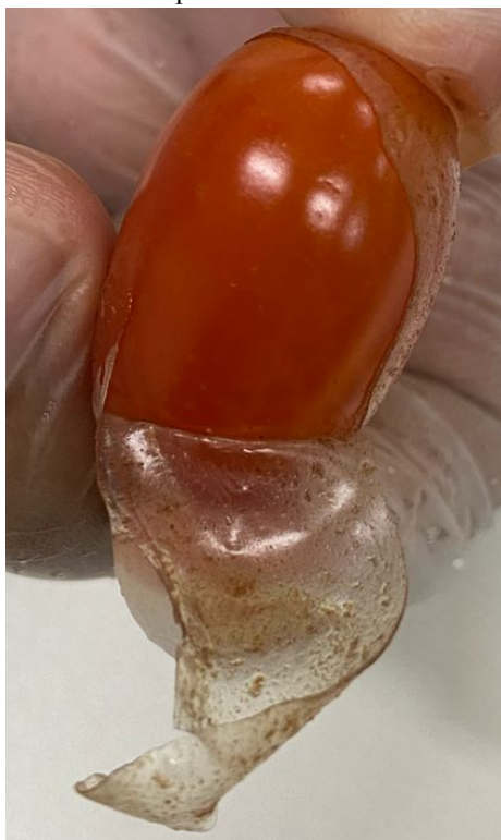
Figura 5.6 - Película de bioplástico sendo removida do tomate cereja.
