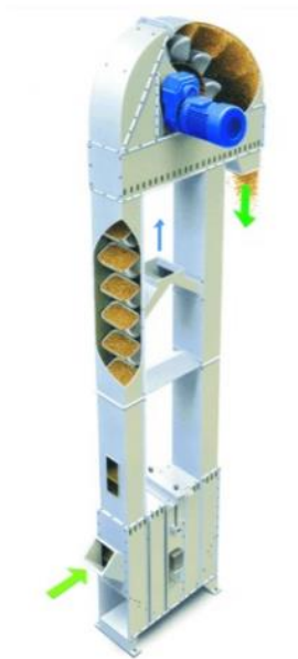
Figura 6 - Modelo 3D Elevador de Canecas
