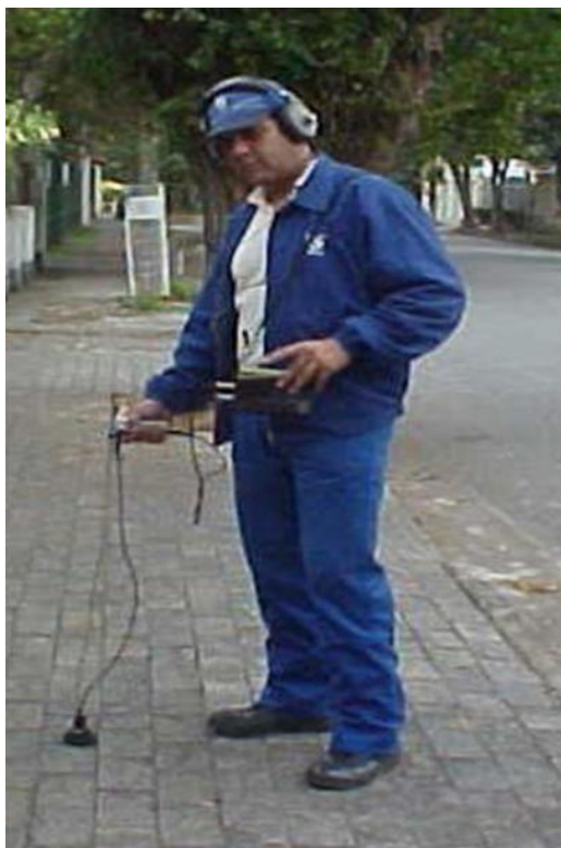
Figura 6 - Utilização do Geofone para localização de vazamentos
