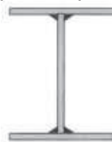
Figura 15: Exemplos de perfil I soldado
