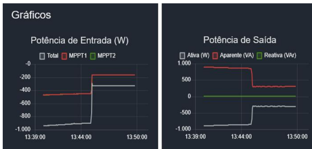
Figura 146 - Operação do inversor fotovoltaico com a potência de injeção limitada Fonte: autoria própria
