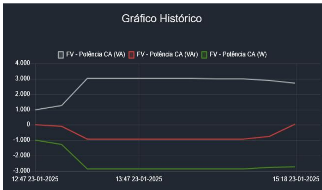
Figura 160 - Resposta da programação de alteração do fator de potência do inversor fotovoltaico Fonte: autoria própria
