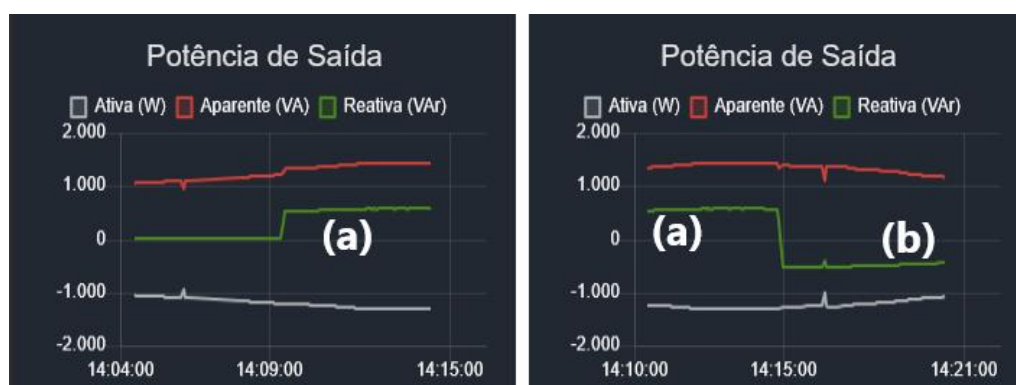
Figura 148 - Operação do inversor com fator de potência (a) indutivo e (b) capacitivo Fonte: autoria própria
