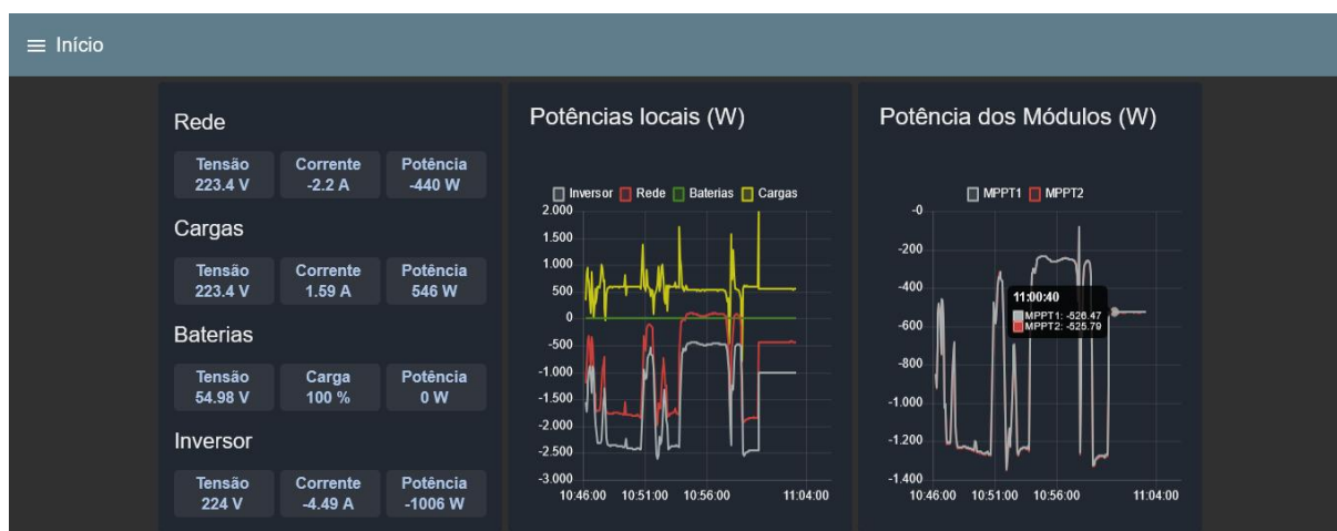
Figura 143 - Guia de supervisão geral dos inversores Fonte: autoria própria
