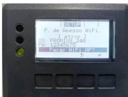
Figura 16 - Ativação do ponto de acesso Wi-Fi do inversor fotovoltaico Fonte: autoria própria
